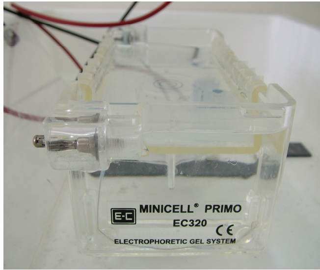
Resim 7. Çalışmamızda kullandığımız agaroz jel elektroforez cihazı.
