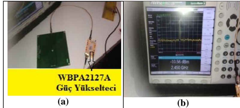
Şekil 5.2. a) WanTcom WBPA2127A güç yükselteci b) Spektrum çıktısı
