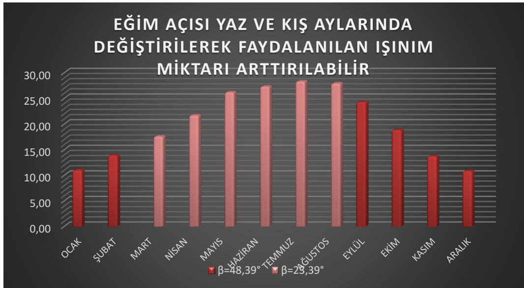
Şekil 5.10 Eğim açısı yaz ve kış aylarında değiştirildiğinde faydalanılan ışınım miktarı arttırılabilir
