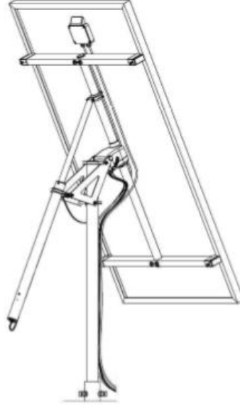
Şekil 5.1. Güneş panelinin sisteminin mekanik yapısı (Beyoğlu, 2011)
