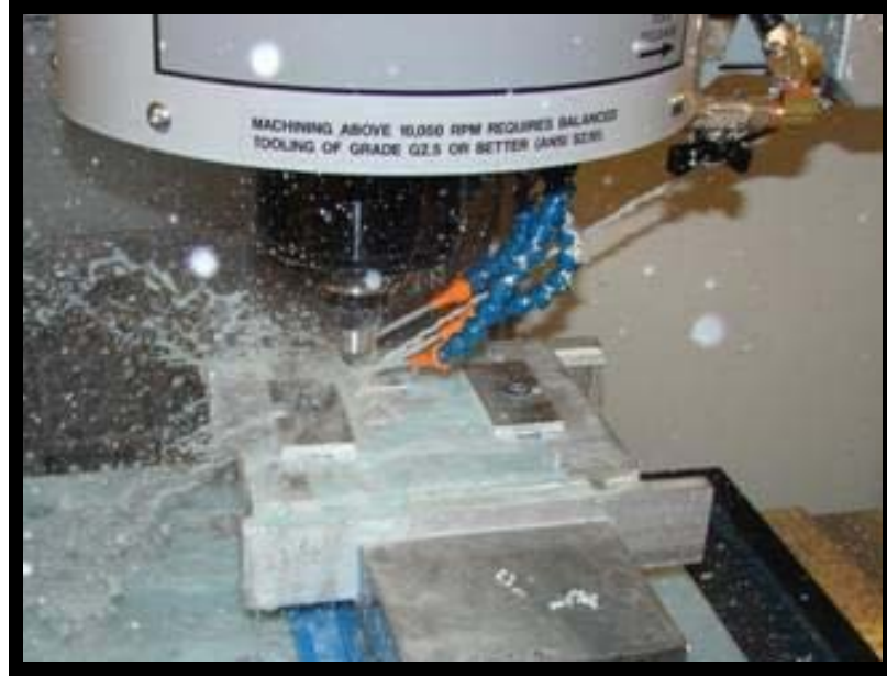
Şekil 9: Alüminyum stepwedge'in hazırlanmasına kullanılan talaşlı imalat tekniği
