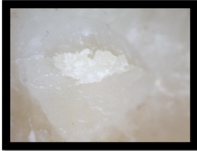
Şekil 20. Mine yüzeyinde görülen koheziv başarısızlık
