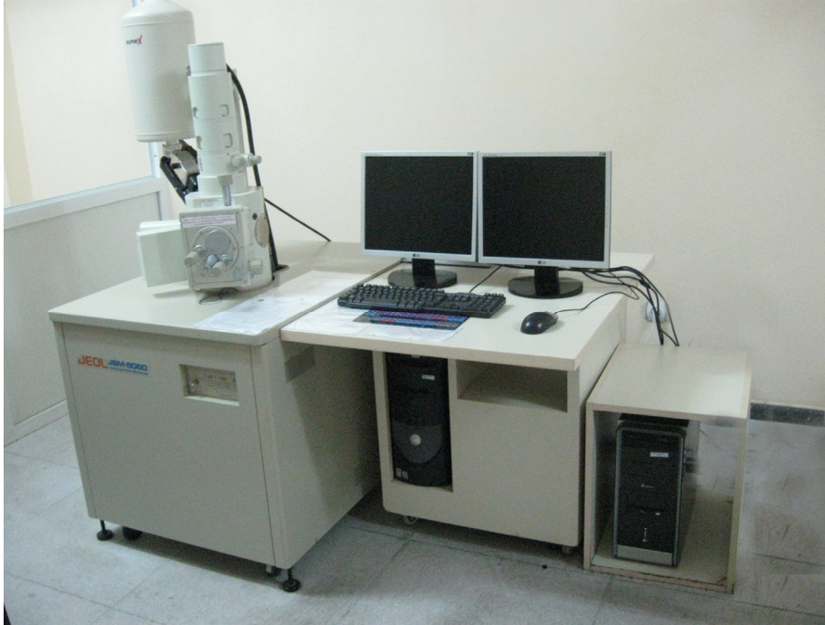
Şekil 13: SEM-EDS cihazı (JEOL, JSM-6060).
