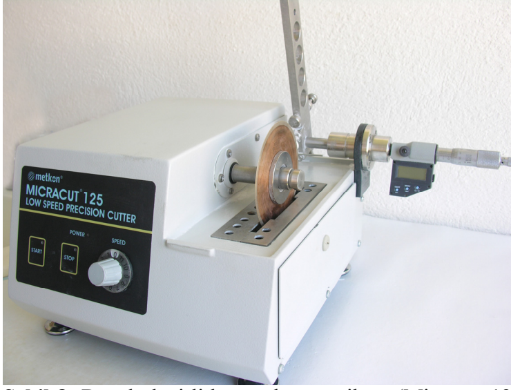
Şekil 8: Düşük devirli hassas kesme cihazı (Micracut 125, Metkon) ve elmas kesme diski (Dimos, Metkon).
