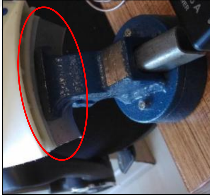
Şekil 4.18: Tek kanat modal testi için yapılan sabitleme şekli.
