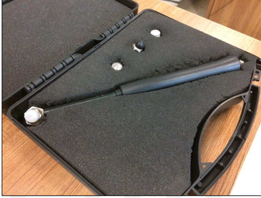
Şekil 4.9: Deneysel modal analiz çekiçi.
