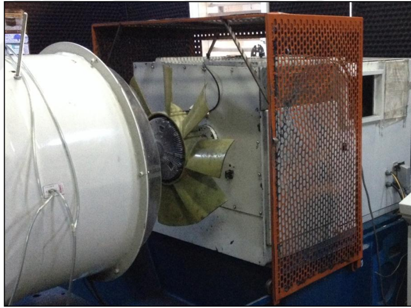
Şekil 2.3: Viskoz fan kavrama test düzeneği.
