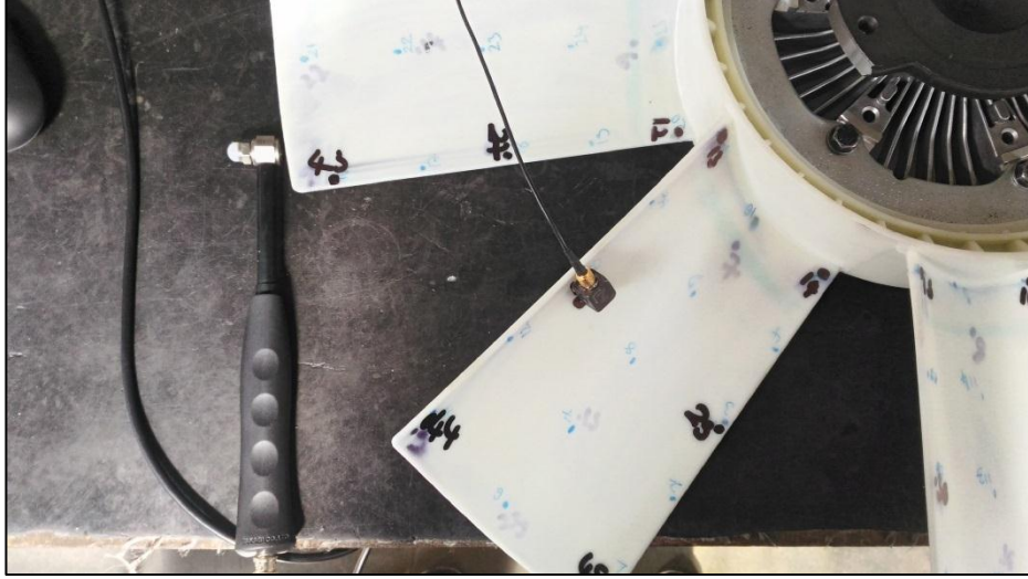
Şekil 4.32: Fan yapısı modal testi için ivmeölçerin yerleşimi.
