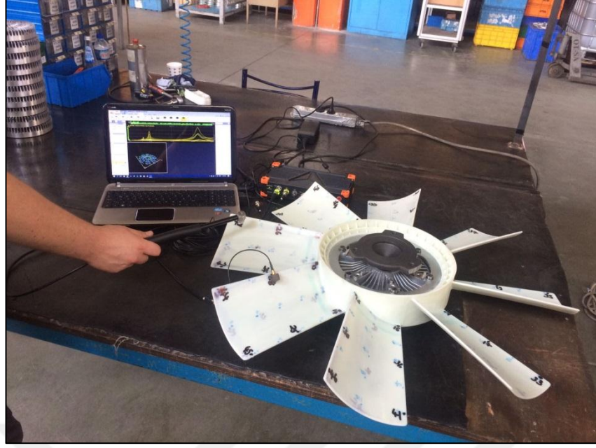
Şekil 4.30: Fan yapısı modal test ölçümleri şekli.
