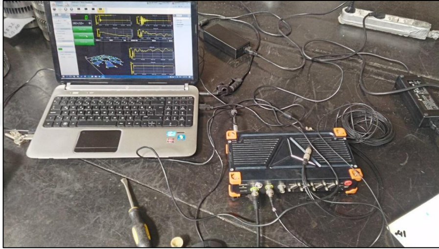
Şekil 4.29: Veri toplama cihazı SIRIUS ve bilgisayar arayüzü gösterimi.
