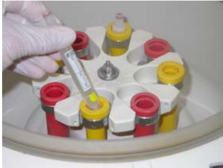
Resim 8: Sarı tüpün santrifüj cihazı içerisine yerleştirilmesi.
