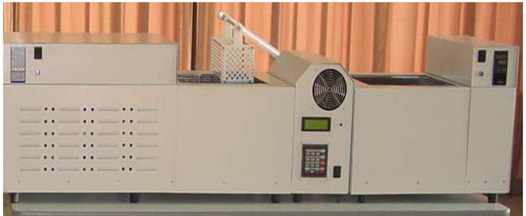
Resim 1. Thermocycler THE 1100 Termalsiklus test aygıtı (www.willytec.com, Erişim tarihi: 21 Mart 2010)
