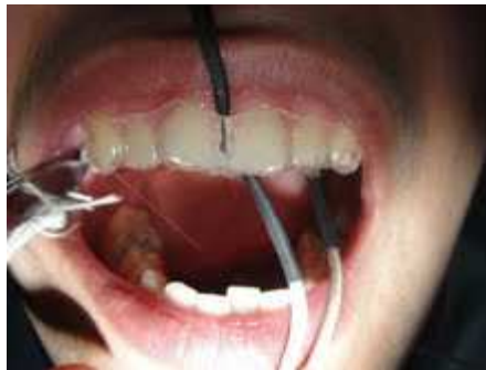
Resim 16. Üzerine termokupl yerleştirilmiş plastik splintin ağızdaki görüntüsü
