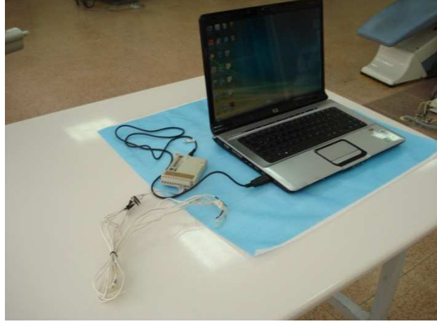
Resim 17. Üzerinde algılayıcı bulunan plastik splintin veri kaydedici ve bilgisayar bağlantısı
