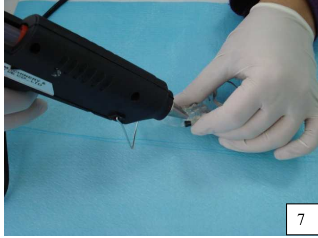
Resim 7. DS18B20 Entegresinin silikon tabancası ve çubuk silikon yardımıyla plastik splint üzerine yerleştirilmesi
