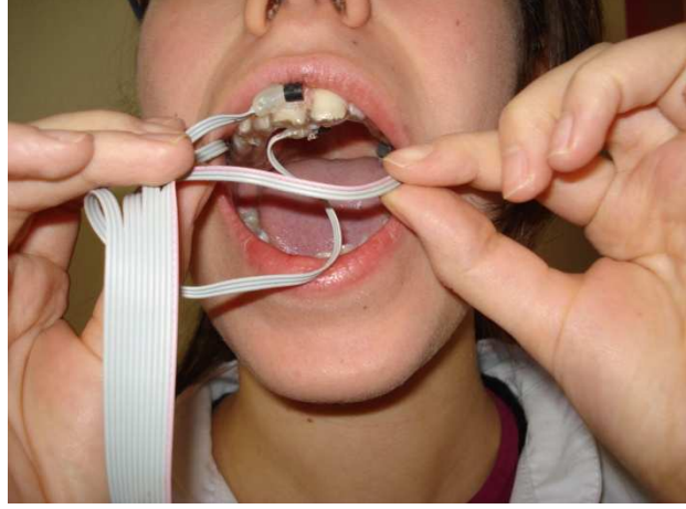
Resim 10. Üzerine DS18B20 Entegresi yerleştirilmiş plastik splintin ağza yerleştirilmesi
