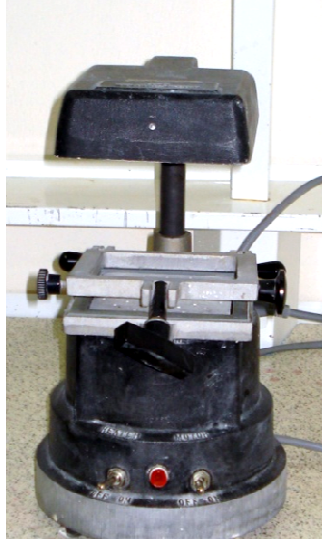
Resim 3. Isı ve basınçla şekillendirme aygıtı (Druformat Scan 115v-Silver, Dentsply, USA)
