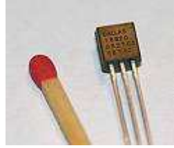
Resim 5. DS18B20 Entegresi (Programlanabilir çözünürlüklü tek hatlı dijital termometre)
