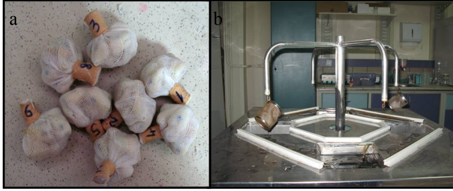
Resim 5. a) Örneklerin termal siklus testi boyunca içinde bulunacakları gazlı bezler, b) cihaza yerleştirilmiş gazlı bezlerin yerleştirildiği kafesler
