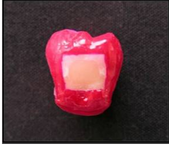
Resim 12. Boya penetrasyonu için hazırlanmış bir örnek
