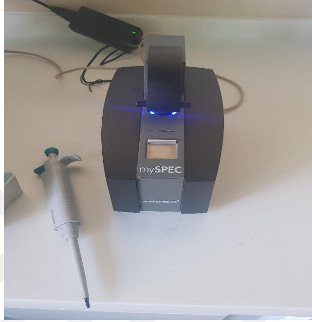
Şekil 3.5. UV spektrofotometre ile mikroorganizma yoğunluğu ölçümü
