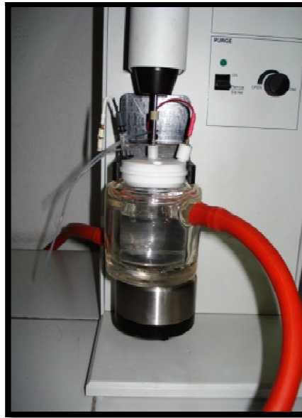
Resim 4. Potansiyostat ile bağlantıları yapılmış elektrotların görüntüsü
