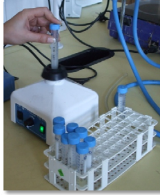
Resim 5: Flakonların vorteks cihazında çalkalanması.
