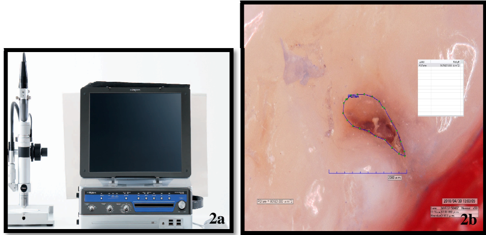
Resim 2a, 2b: Çürük alanlarının 3 boyutlu olarak hesaplanabildiği dijital mikroskop ve alan hesaplaması görüntüsü (153 no'lu diş)
