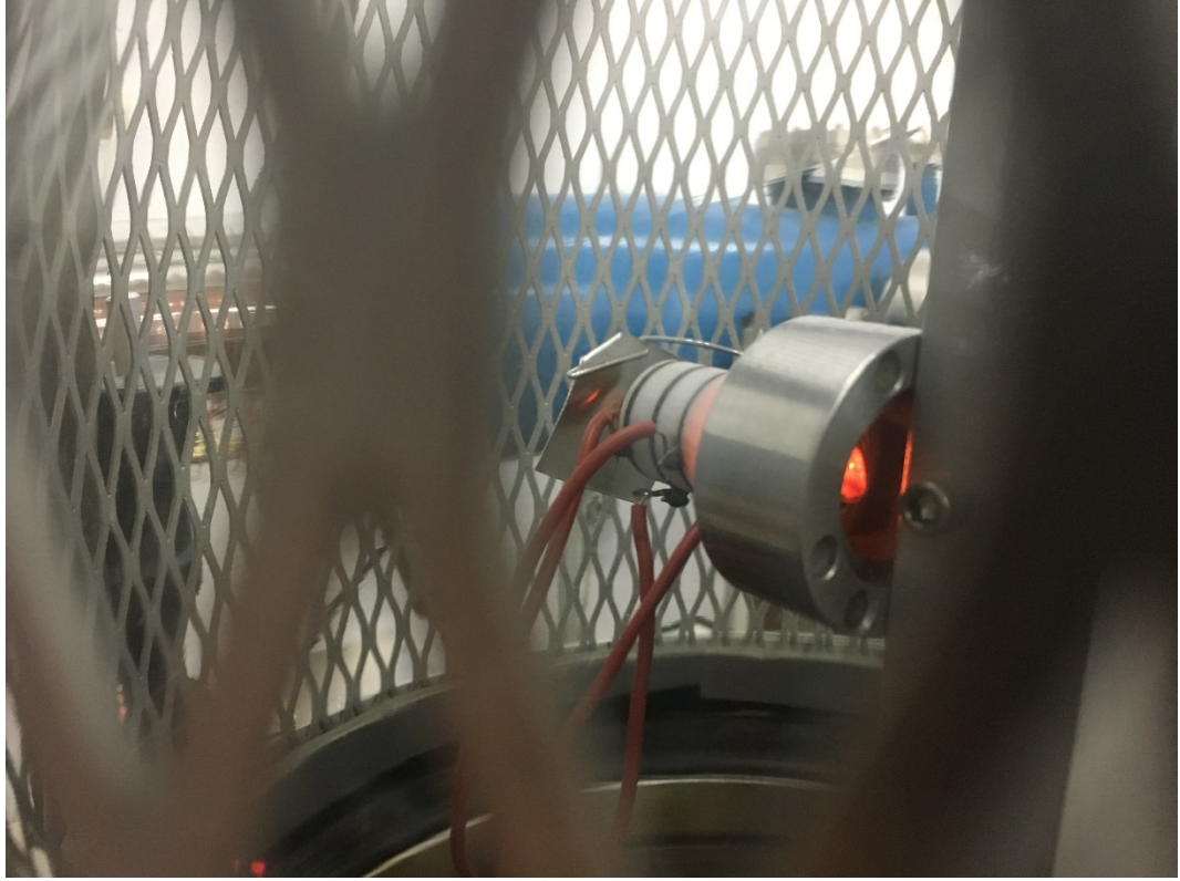
Şekil 3.8. TWT sisteminde kullanılan elektron tabancası
