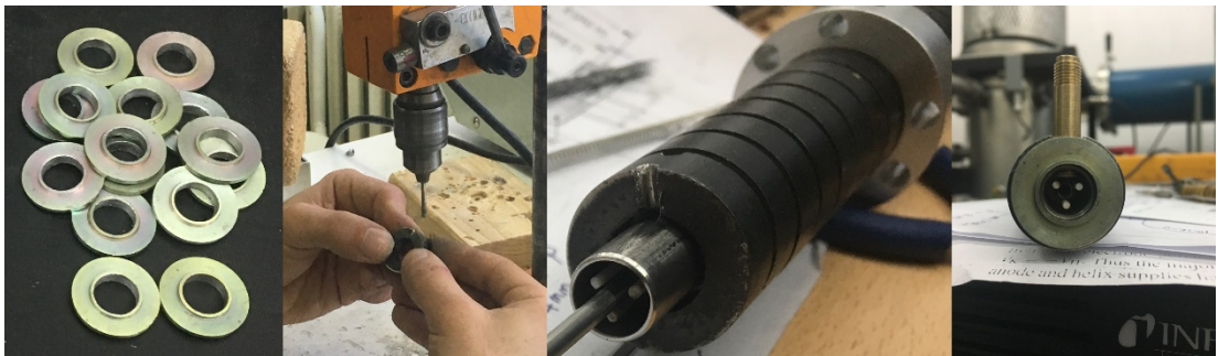
Şekil 3.7. Alnico halka mıknatıslar kullanılarak periyodik mıknatıs sisteminin oluşturulması ve SMA konektör yuvalarının açılması
