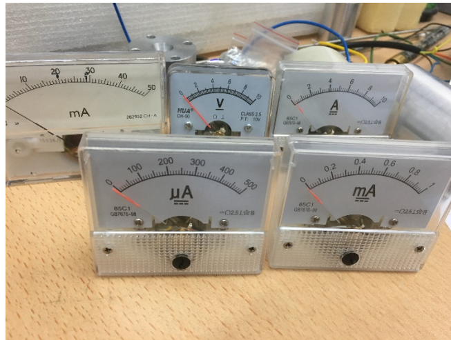
Şekil 3.10. Elektron demetinin akımını ölçmek için kullanılan analog DC ampermetreler
