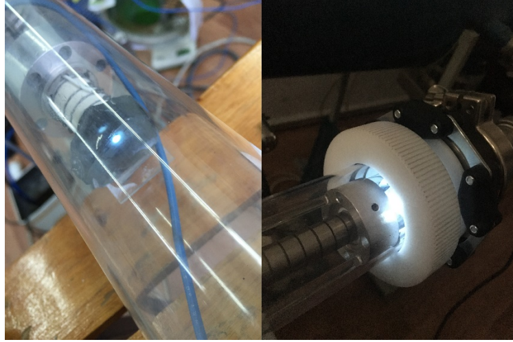
Şekil 3.9. Fosfor ekran kullanılarak elektron demetinin gözlemlenmesi
