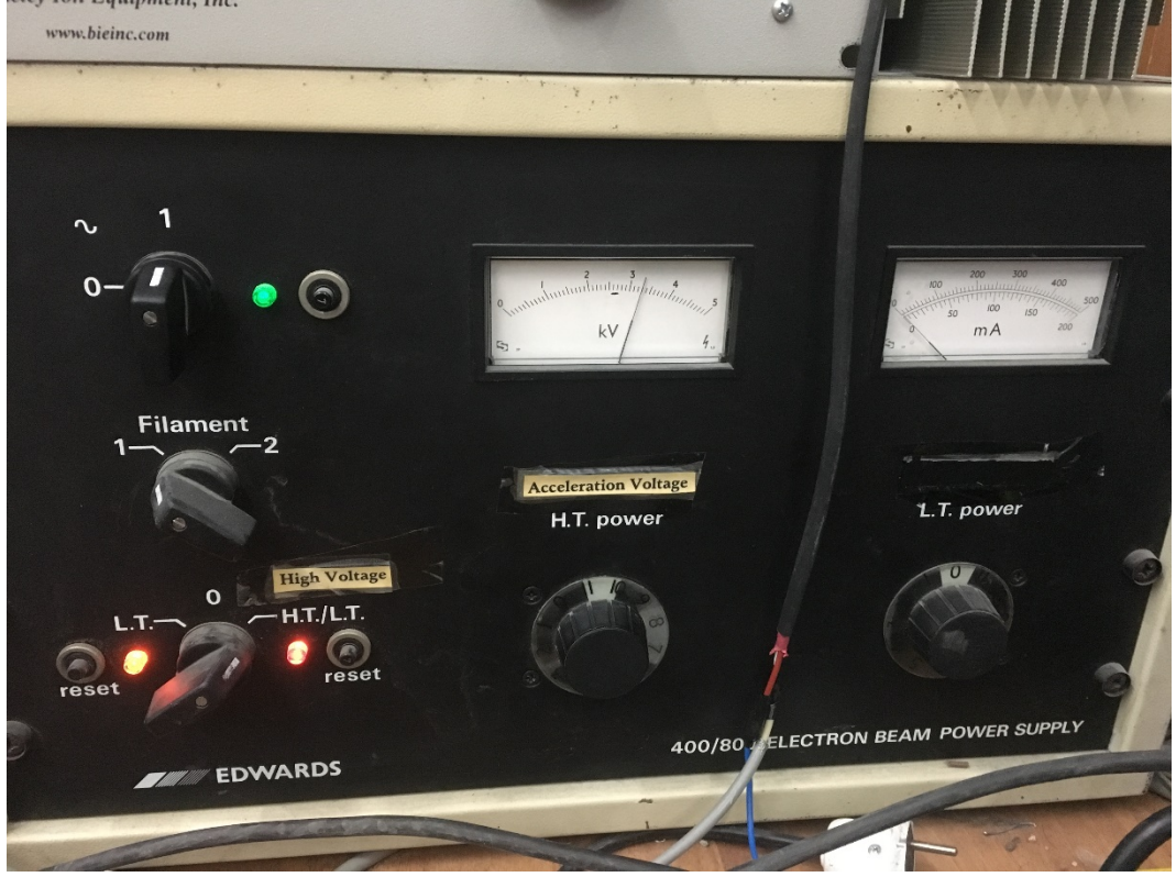
Şekil 3.3. Elektron demetini hızlandırmak için kullanılan Edwards 400/800 model yüksek voltaj DC güç kaynağı
