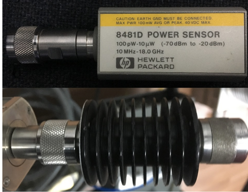
Şekil 3.23. RF çıkışının ölçülmesinde kullanılan HP 8481D model güç sensörü ve zayıflatıcı
