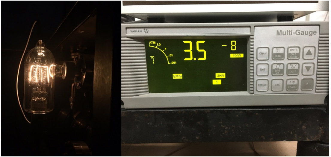
Şekil 3.12. Sistemin basınç değerinin ölçülmesi için kullanılan sıcak katot vakum sensörü ve Varian marka yüksek vakum sensörü monitörü
