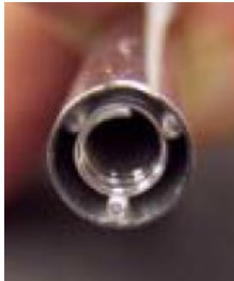
Şekil 2.33. Seramik destek çubukları ile helis yapısının merkezlenmesi (Song vd. 2013)
