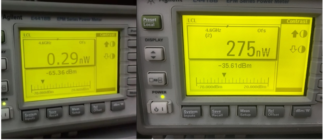
Şekil 3.22. RF çıkış portunun sinyal gücünü ölçmek için kullanılan Agilent marka E4418B model güç metre
