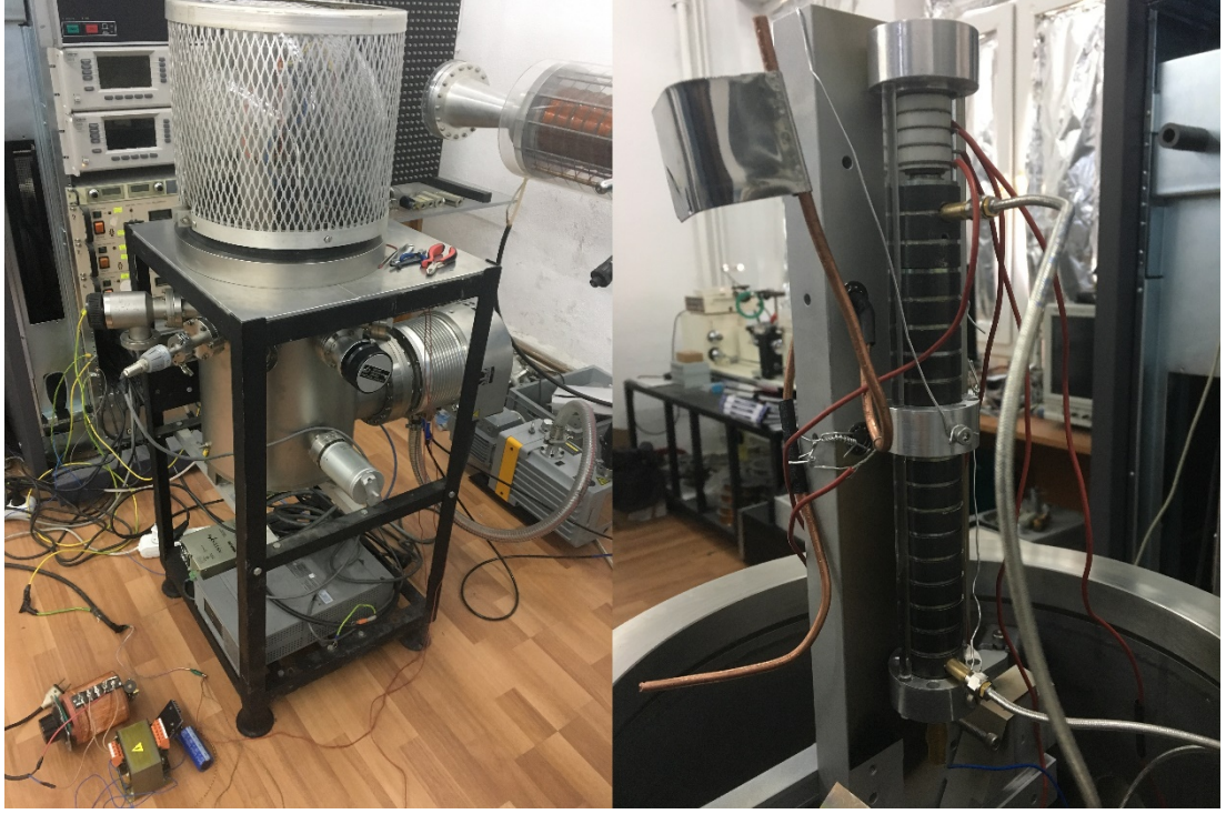
Şekil 3.11. TWT sisteminin atmosfer koşullarını sağlamak için kullanılan vakum haznesi ve TWT sisteminin montajının yapılması
