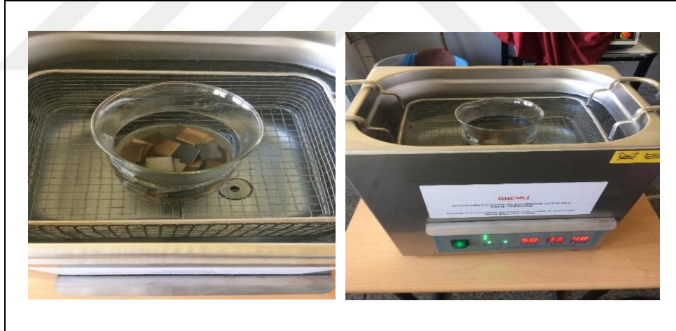
Şekil 3.2. Deney numunelerinin temizlendiği ultrasonik temizleme cihazı
