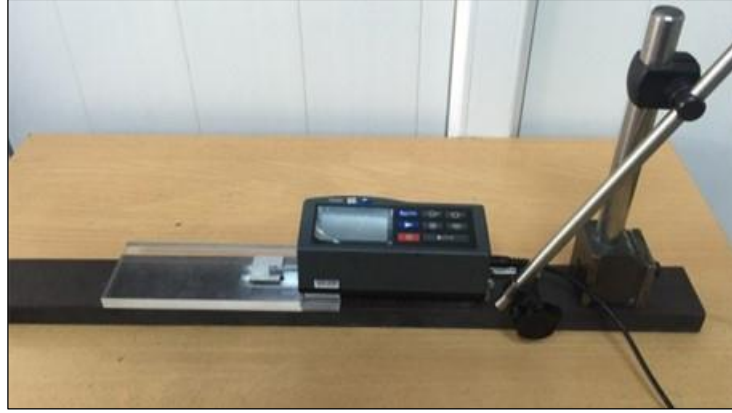
Şekil 3.3. Yüzey pürüzlülük ölçüm cihazı ve örnek ölçüm
