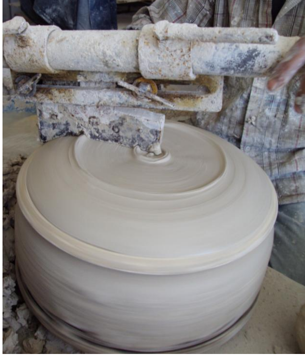
Şekil 3. Dış Sıvama Yöntemi
