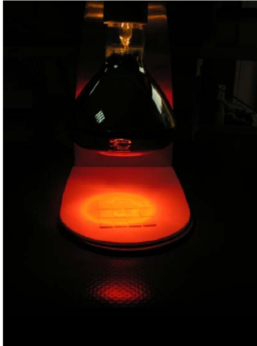
Resim 3.3: Deney örneklerinin ışık altında kurutma işlemi
