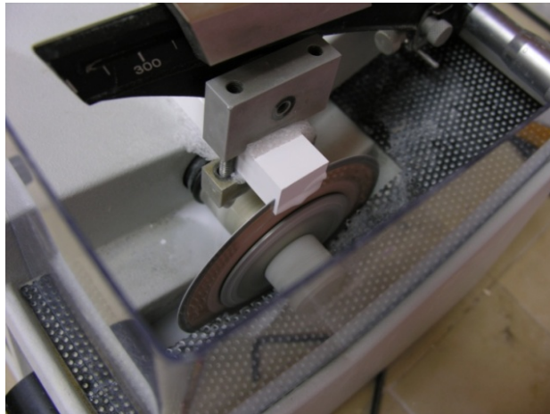
Resim 3.2: Deney örneklerinin mikrocüt cihazıyla hazırlanışı
