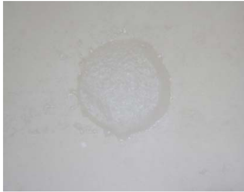
Resim 4.2 Koheziv şekilde kopma gösteren bir örnek (x10)
