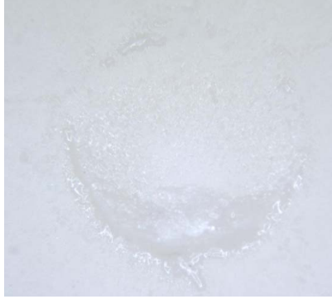
Resim 4.3 Kombine şeklinde kopma gösteren bir örnek (x20)
