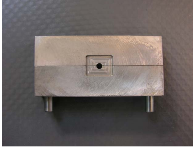
Resim 3.4: Üst yapı seramiğinin hazırlanmasında kullanılan metal şablon
