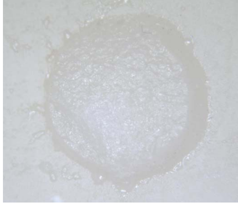
Resim 4.4 Koheziv şeklinde kopma gösteren bir örnek (x20)
