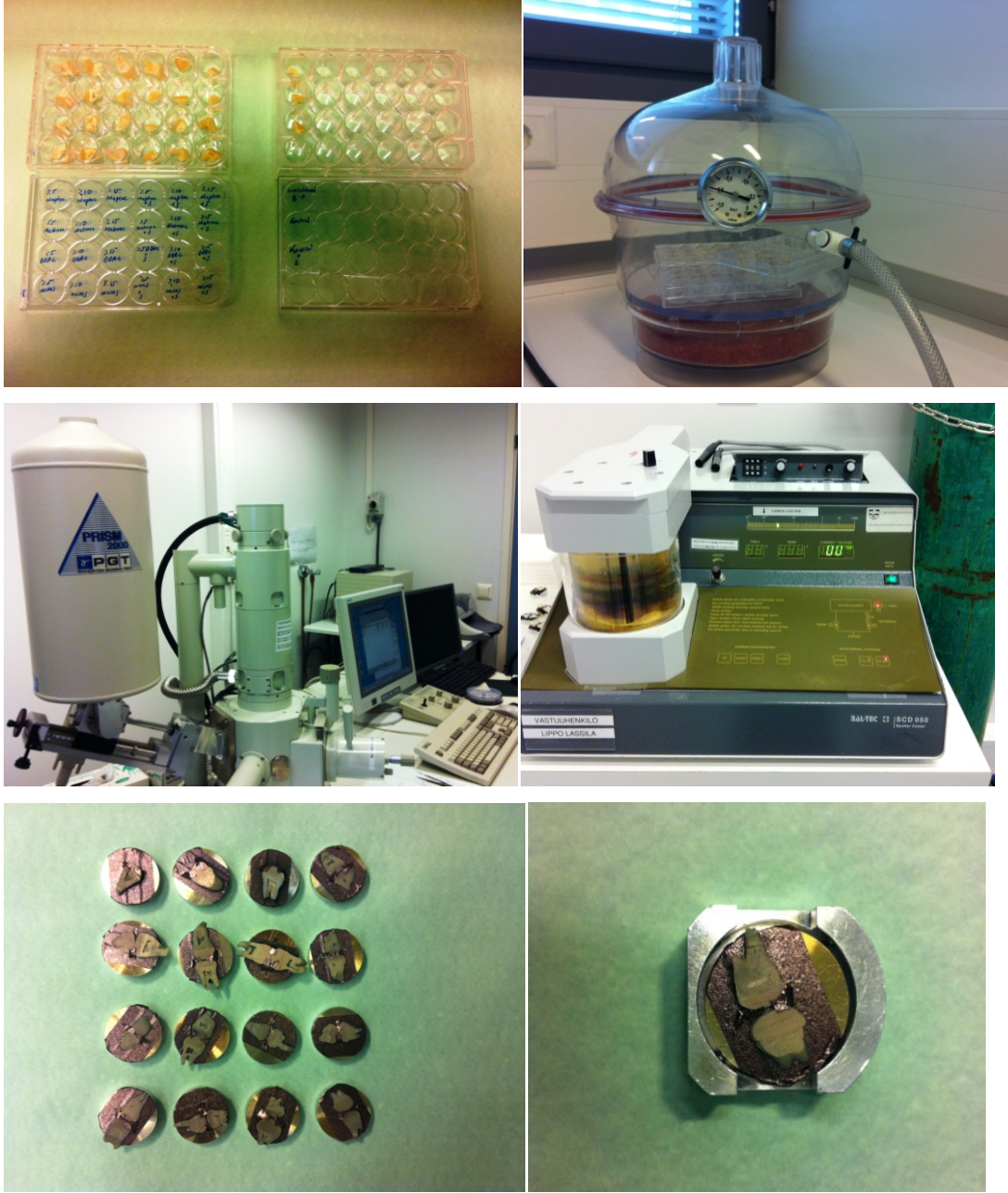
Resim 9. SEM örnekleri hazırlanması ve Au-Pt alaşımı kaplı örnekler
