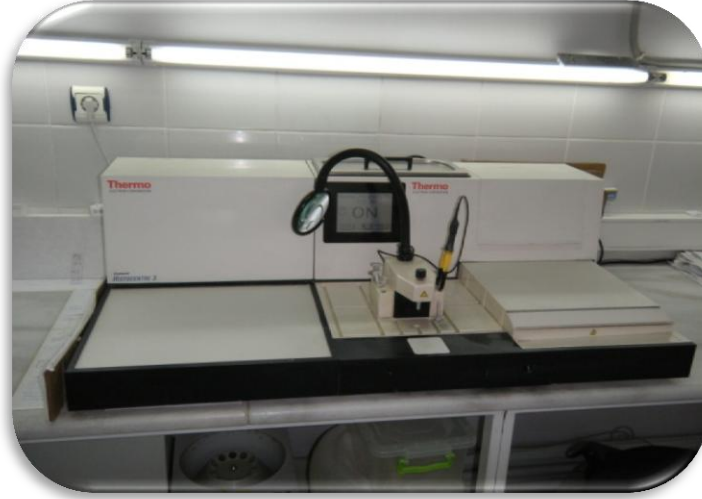
Resim 24. Blokları -20^{\circ}\text{C} 'de dondurma cihazı
