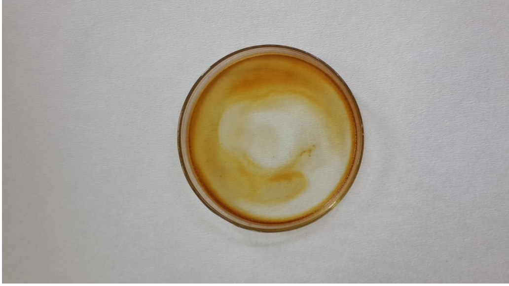
Şekil 4.6. İndirgeme yöntemi sonucu elde edilen keratin yapısı
