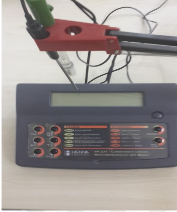
Şekil 3.3. Hanna pH metre (HI 221) ve iletkenlik ölçüm cihazı
