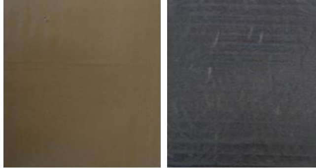
Şekil 3.3. Baryum sülfat (a) ve tungsten (b) ile kaplanmış kumaşlar
