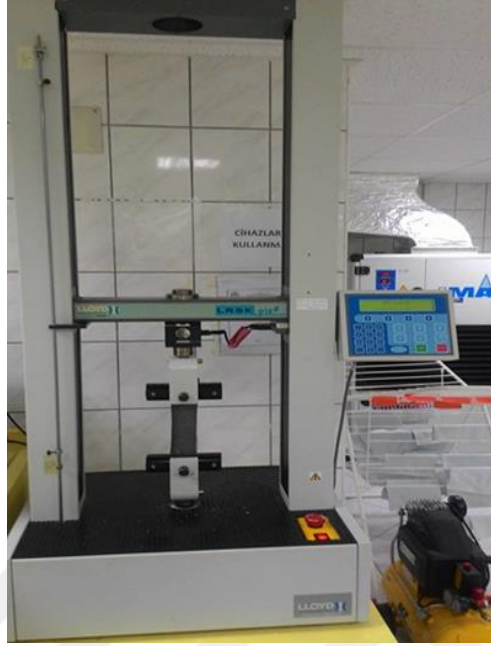
Şekil 3.7. Kaplama kumaşa kopma mukavemeti testinin uygulanışı
