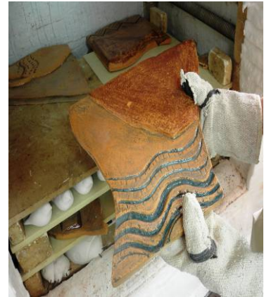
Resim 62: Sır Fırınından Çıkarılması
