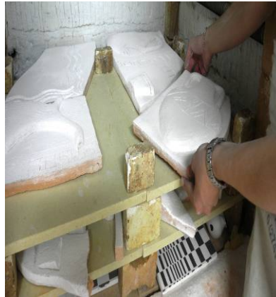
Resim 61: Sır Fırınına Yerleştirme
