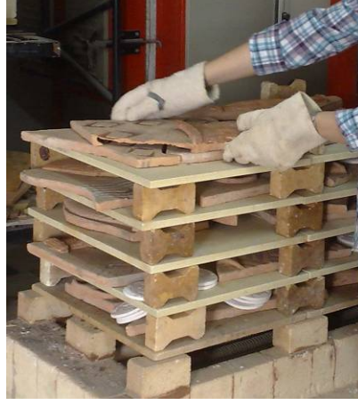
Resim 59: Bisküvi Pişirimi Olan Pano Parçaları, Fırın Boşaltımı
