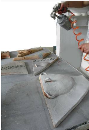
Resim 60: Pistole İle Sırlama
