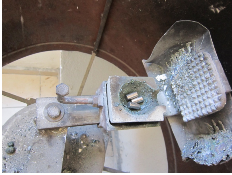
Resim 12. Metal alařım silindirlerin santrifüj öncesi döküm yatađına yerleřtirilmesi
