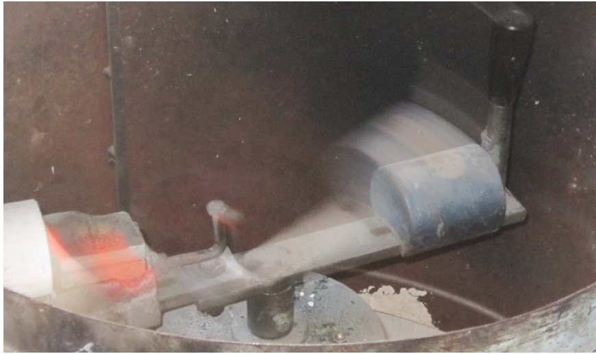
Resim 13. Metal alařım silindirlerin eritilmesinin ardından santrifüj uygulanması
