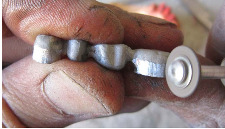
Resim 18. Metal köprüde tesviye işlemi
