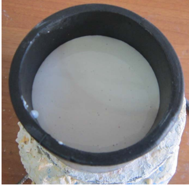
Resim 10. Revetmanın vibratör yardımıyla manşete dökülmesi
