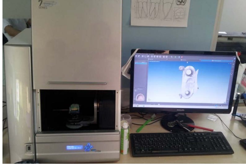
Resim 23. Taranan dublikat modellerin bilgisayar ortamına aktarılmış görüntüleri
