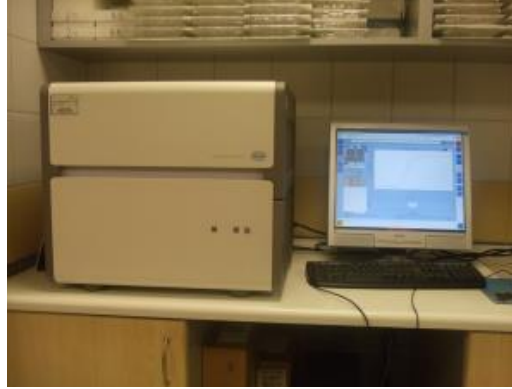
Resim 7: Analizlerin gerçekleştirildiği Real Time PCR cihazı, Roche LightCycler 480 (Kocaeli Üniversitesi - KÖGEM).
