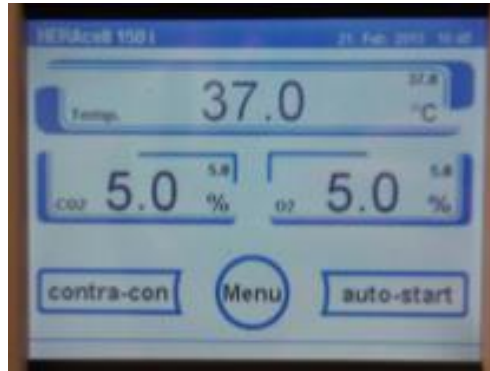
Resim 2: İnkübatörün gösterge panelinden izlenen deney ortam şartları. Sıcaklık 37°C'de, CO 2 % 5 ve O 2 % 5 seviyesinde görülüyor.
