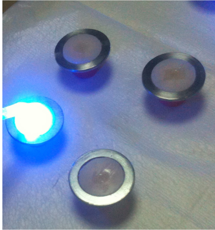
Resim 22. Rezin simanın uygulanması ve polimerizasyonu
