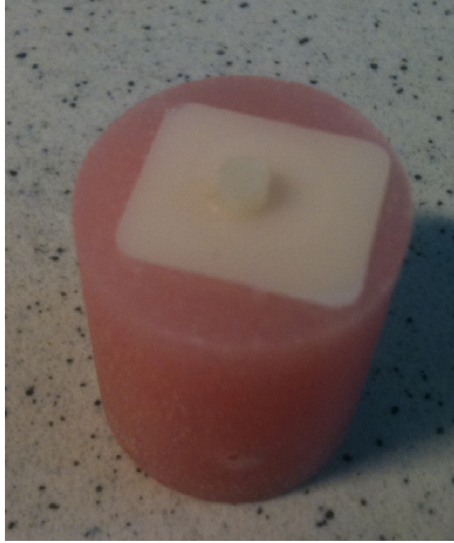
Resim 25. Dual-kür rezin siman bağlanmış örnekler
