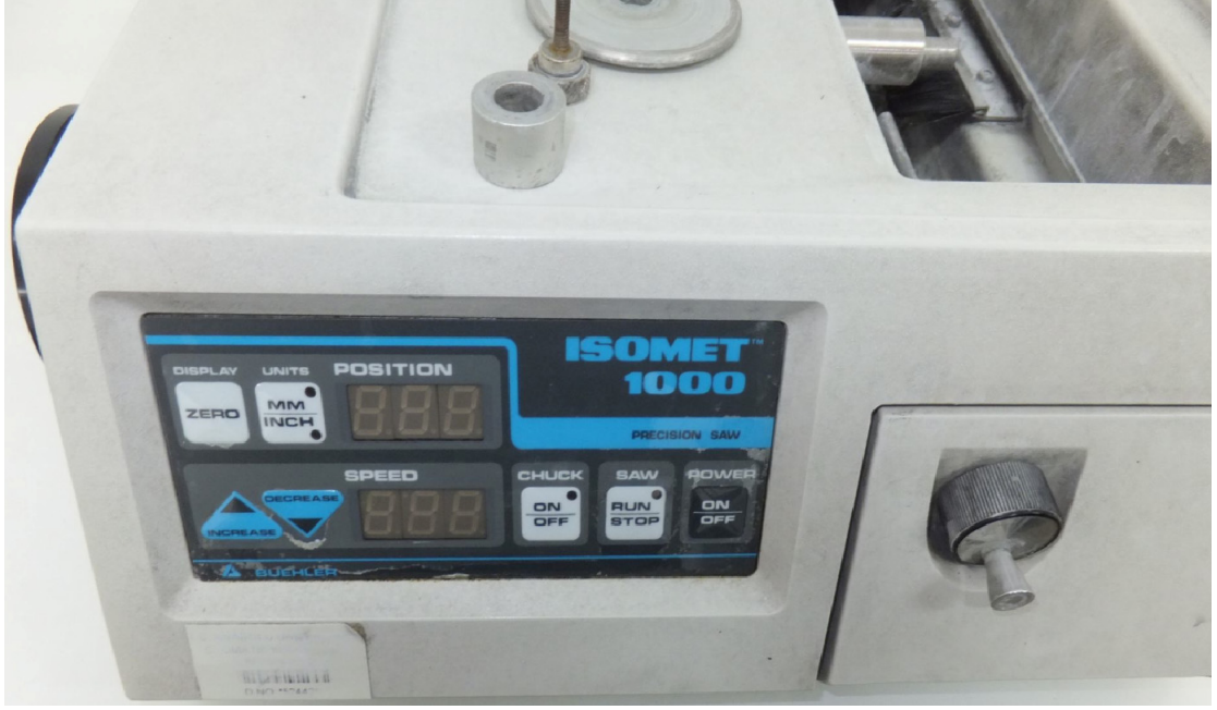
Resim 2. Seramiklerin kesiminde kullanılan kesici
