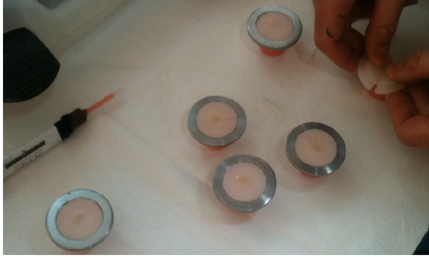
Resim 24. Teflon kalıpların örneklerden uzaklaştırılması
