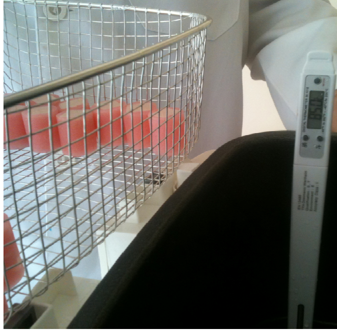
Resim 17. Seramiklerin sıcak su banyosuna yerleştirilmesi
