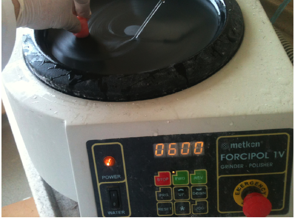
Resim 10. Yüzey düzeltme işleminin gerçekleştirilmesi
