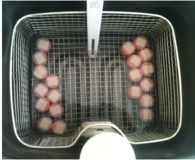
Resim 18. Seramikler 85°C derece sıcak su banyosunda
