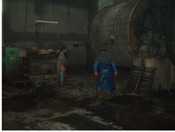
Şekil 118. : Derinin dolaptan dökülmesi (Halit Özdamar).
