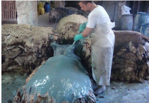
Şekil 114. : Zırnıklama işlemi (Halit Özdamar).
