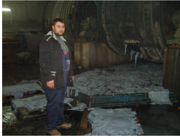
Şekil 121. : Derilerin dolaptan dökülmesi (İbrahim Atalar).
