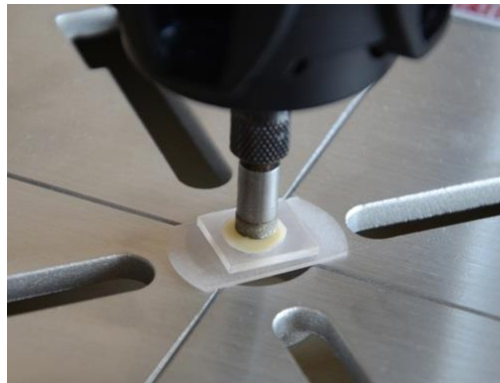
Resim 14. 6 mm çapındaki dentin disklerinin elde edilmesi.
