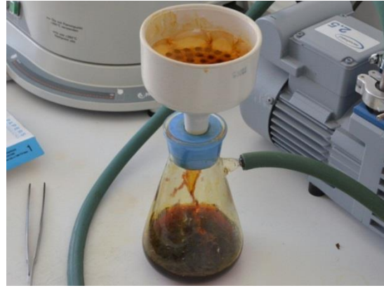
Resim 6. Filtre kağıdı ve vakum pompası kullanılarak ekstraktın süzülmesi.
