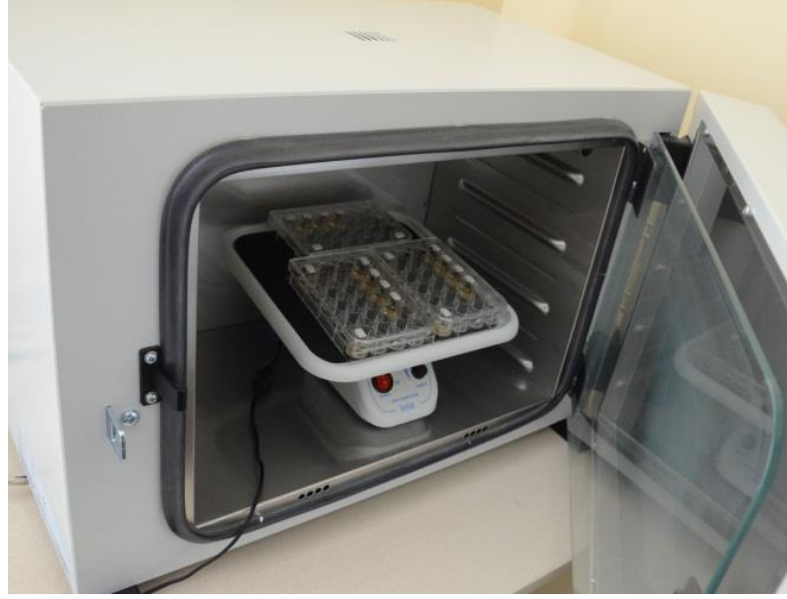
Resim 20. Bakteriyel süspansiyon eklendikten sonra, hazırlanan plağın üç boyutlu çalkalayıcı tabla üzerinde 37^{\circ}\text{C} 'de inkübe edilmesi.
