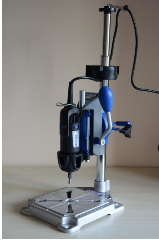
Resim 15. Dentin disklerinin elde edilmesi için oluşturulan standart düzenek.
