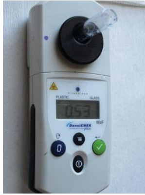
Resim 9. Densitometre cihazı kullanılarak 0,5 McFarland bulanıklığa eşit olacak şekilde bakteriyel süspansiyonun hazırlanması.
