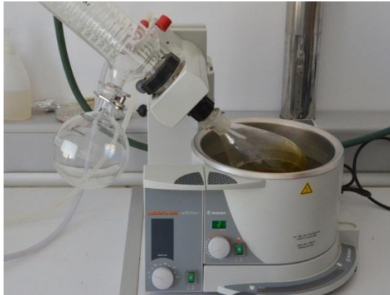
Resim 7. Rotary evaporatör kullanılarak ekstrakt içerisindeki metil alkol ve distile suyun uzaklaştırılması.
