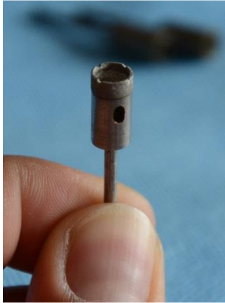
Resim 13. Dentin disklerinin elde edilmesinde kullanılan özel yapım elmas kaplı silindirik frez.
