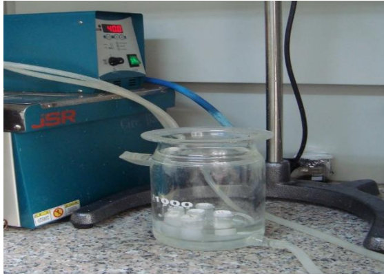
Şekil 3.5. Bulanıklaşma testi ve AKÇS değerinin belirlenmesi sırasında kullanılan sıcaklığı ayarlanabilen emülsiyon sistemi
