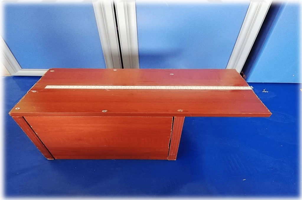
Şekil 25. Esneklik Test Sehpası.
