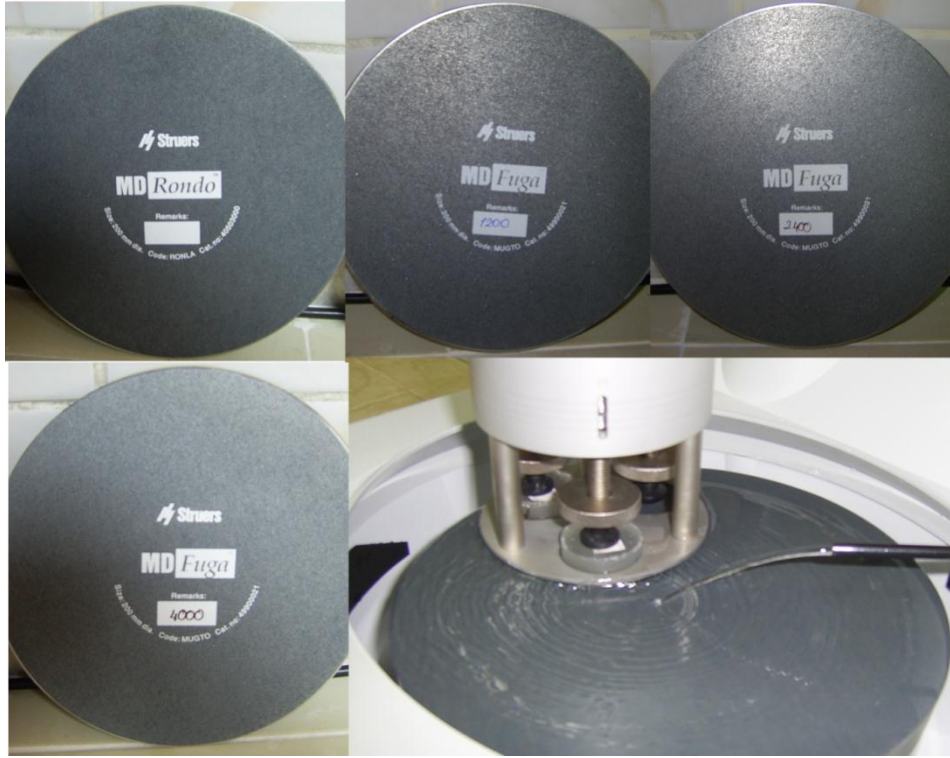
Resim 16. Örnek yüzeylerinin parlatma işleminin yapıldığı zımparalar
