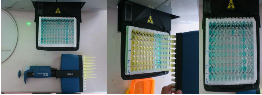
Resim 4. Otomatik kuyucuk okuyucu cihazı (Plate Reader Fluorescence, Infinite 200 PRO, TECAN, Avusturya)
