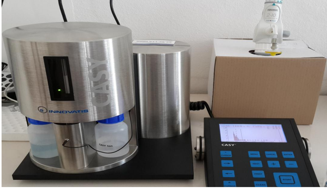
Resim 8. Biyofizik Laboratuvarında kullandığımız Casy TT system hücre sayım cihazı (Almanya)
