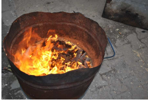
Resim 138: Seramiklerin Talaşın İçine Redüksiyonları Yapılırken.
