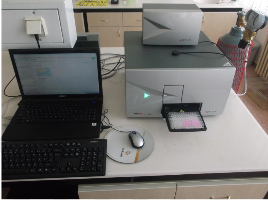
Resim 2. Floresans ve spektrofotometrik analizlerin yapıldığı kuyucuk okuyucu (plate reader) cihazı.
