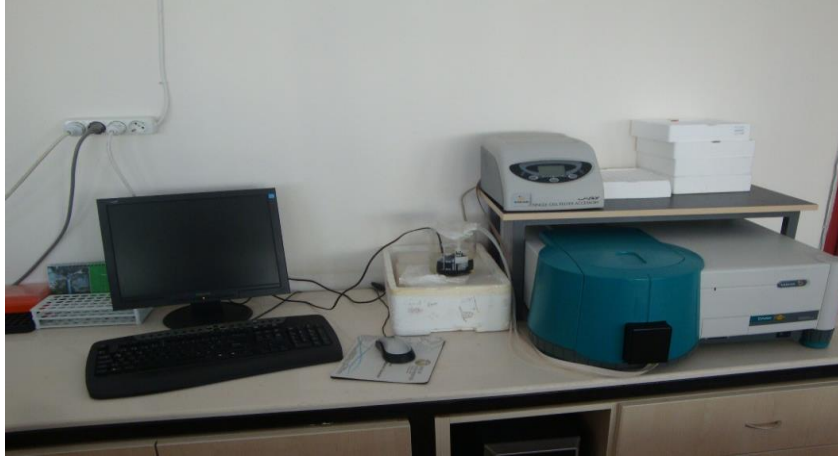
Resim 1. Kalsiyum sinyali analizlerinin yapıldığı spektrofluorometre cihazı.
