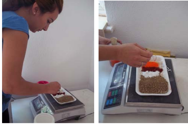
Resim 45: Oksit ve Hammaddelerin Tartımlarının Yapılması
