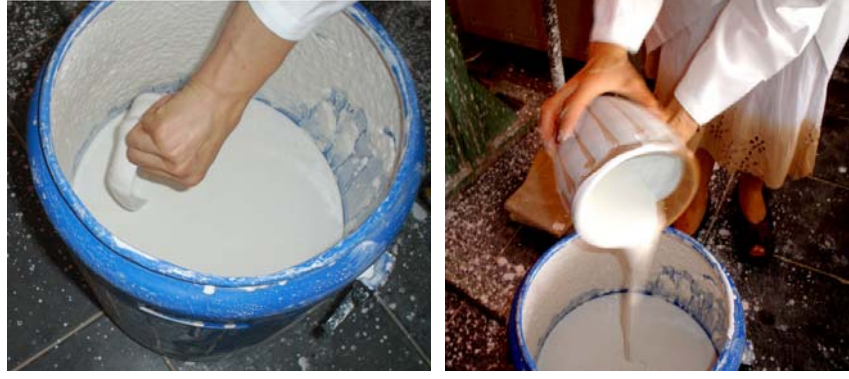
Resim 23: Daldırma Tekniği ile Astarlama
