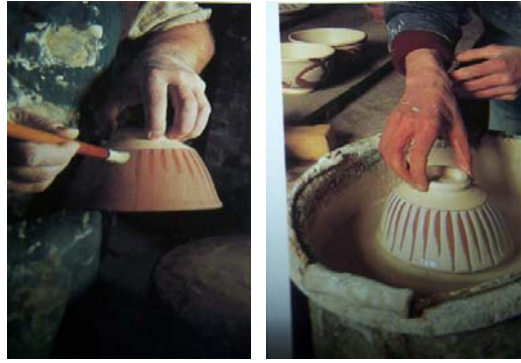
Resim 29: Mum Yöntemi ile Astarlama
