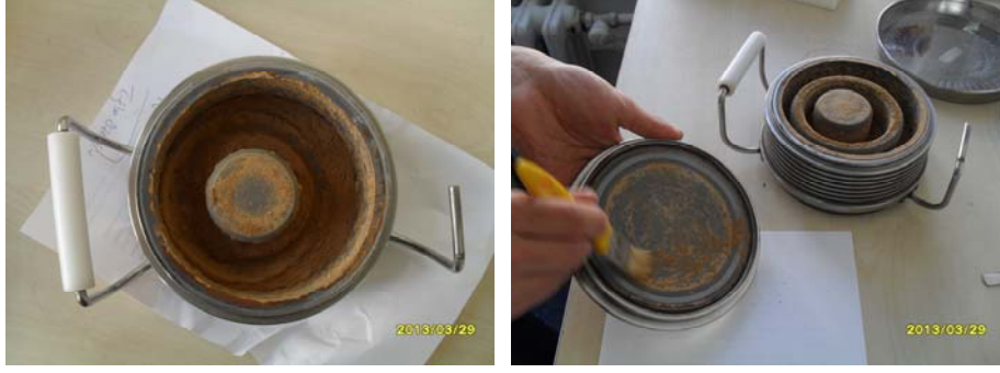
Resim 40: Toz Haline Getirilmiş Kilin Halkalı Aparatı İçerisinden Temizlenişi.
