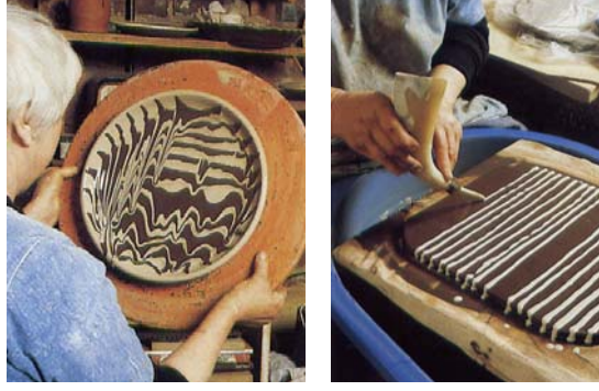
Resim 32: Ebru ve Mermer Dekor Yönteminin Yapılması
