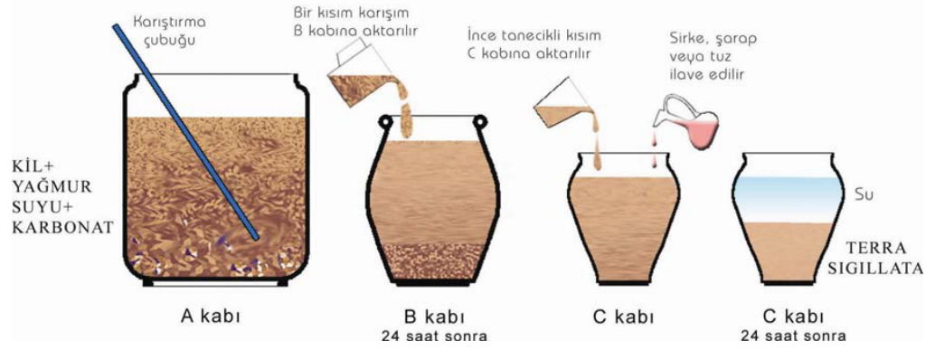
Şekil 3: Çöktürme Yöntemi ile Terra Sigillata Elde Edilmesi
