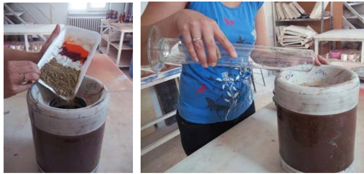
Resim 46: Hazırlanan Hammaddelerin Yağmur Suyu ile Birlikte Değirmene Aktarılması
