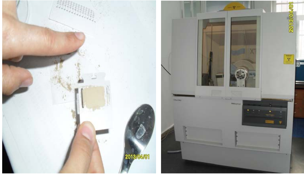
Resim 44: A) X-Ray Cihazı Aparatı İçerisinde Konulan Kil Örneği,
