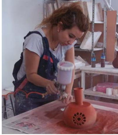
Resim 29: Püskürtme Yöntemi Astarlama
