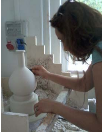
Resim 81: Alçı tornasında yapılacak olan formun şekillendirilmesi
