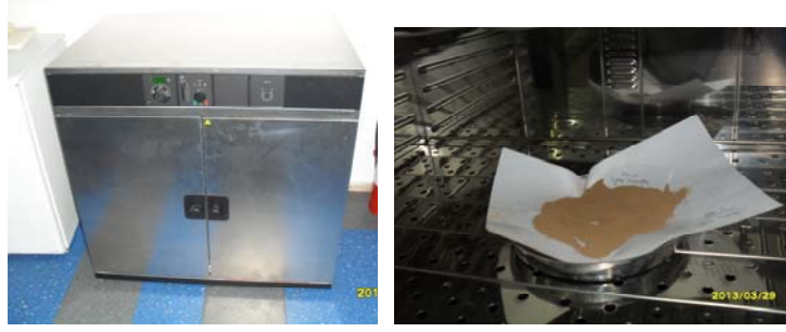
Resim 43: Etüv Cihazı ve Öğütülmüş Kilin Etüv Cihazı İçerisine Konulması
