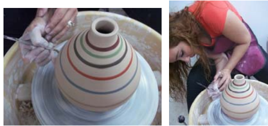
Resim 34: Fırça ile Şeritleme Dekorunun Yapılması
