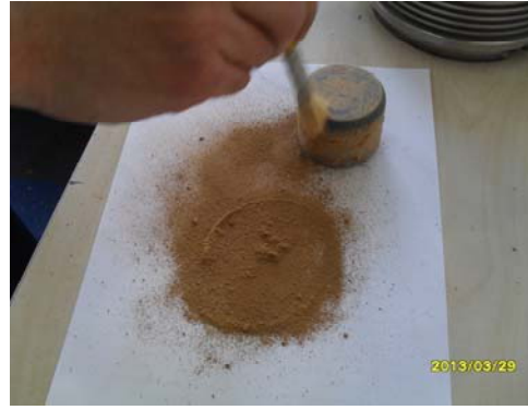
Resim 41: Toz Haline Getirilmiş Kilin Halkalı Aparatı İçerisinden Temiz Bir Yüze Aktarılması
