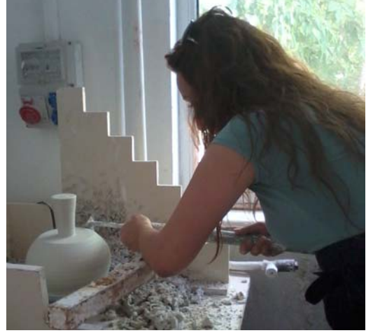
Resim 81: Alçı tornasında yapılacak olan formun şekillendirilmesi
