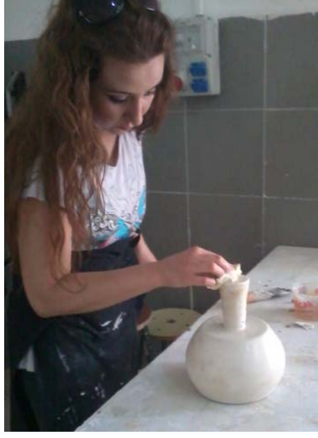
Resim 83: Alçı tornasında şekillendirilen formun kalıp alma işleminin yapılması
