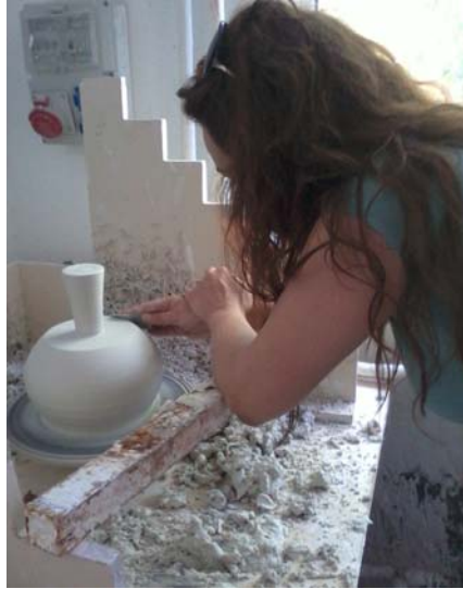
Resim 82: Alçı tornasında şekillendirilen formun su zımparası ile düzeltilmesi
