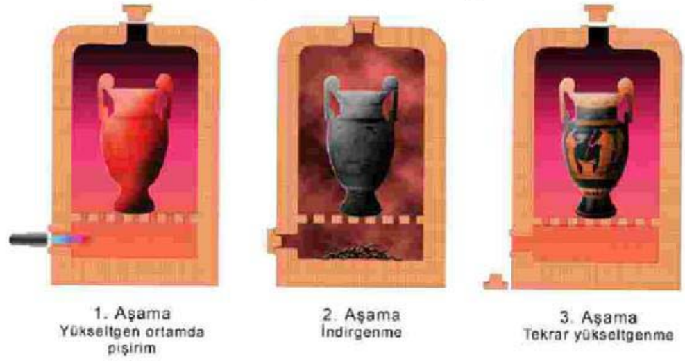
Şekil 4: Üç Basamaklı Pişirim Yöntemi ile Siyah Terra Sigillata Elde Edilmesi
