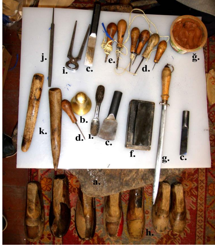
Şekil 79. Yemeni Yapımında Kullanılan Araçlar; a. Kütük Tezgâh, b. Muşta, c. Keskiler, d. Bizler, e. Köşker İğnesi, f. Bileği Taşı, g. Masat, ğ. Kil Ölbesi, h. Kalıplar, ı. Peşkiç i. Kerpeten, j. Eğe, k. İhvan (Aktürk 2012)
