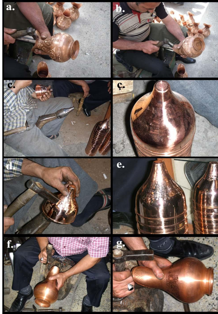
Şekil 27. Dövme Tekniği İle Yapılan Bazı İşlemler; a. Ürünün Ağzının Bükülmesi, b. Ürünün Ağzının Düzeltilmesi, c. Perdah İşlemi İçin Ürüne Özel Yapılmış Örs, ç. Perdahlanmamış Ürün, d. Perdah İşlemi, e. Perdahlanmış Hali, f. Perdahlama İşlemi, g. Perdahlama İşlemi (Aktürk 2012)
