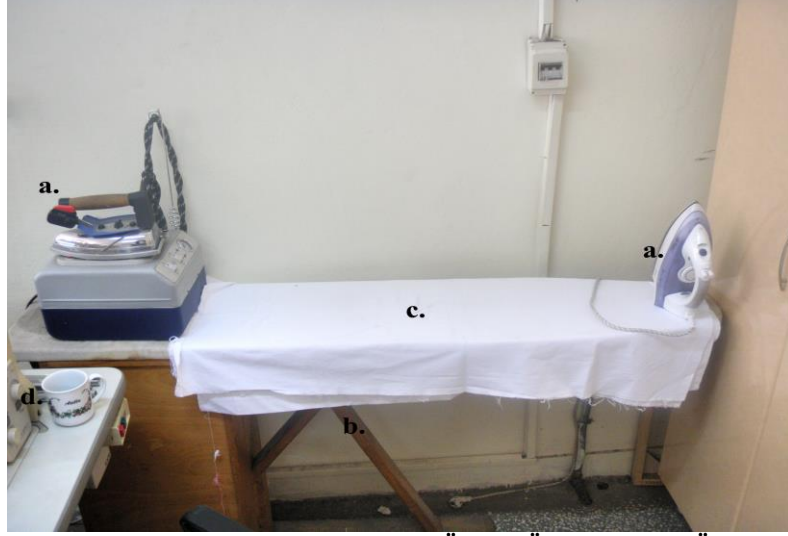
Şekil 4. Ütüleme Sırasında Kullanılan Araçlar; a. Ütü, b. Ütü Masası, c. Ütü Bezi, d. Su Kabı (Aktürk, 2012)
