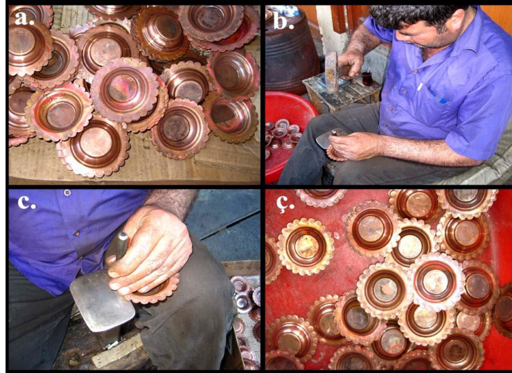
Şekil 33. Zimba Tekniğinin Uygulanışı; a. Uygulanacak Ürünler, b. , c. Zimba Tekniğinin Uygulanışı, ç. Zimba Tekniği Uygulanmış Ürünler (Aktürk 2012)
