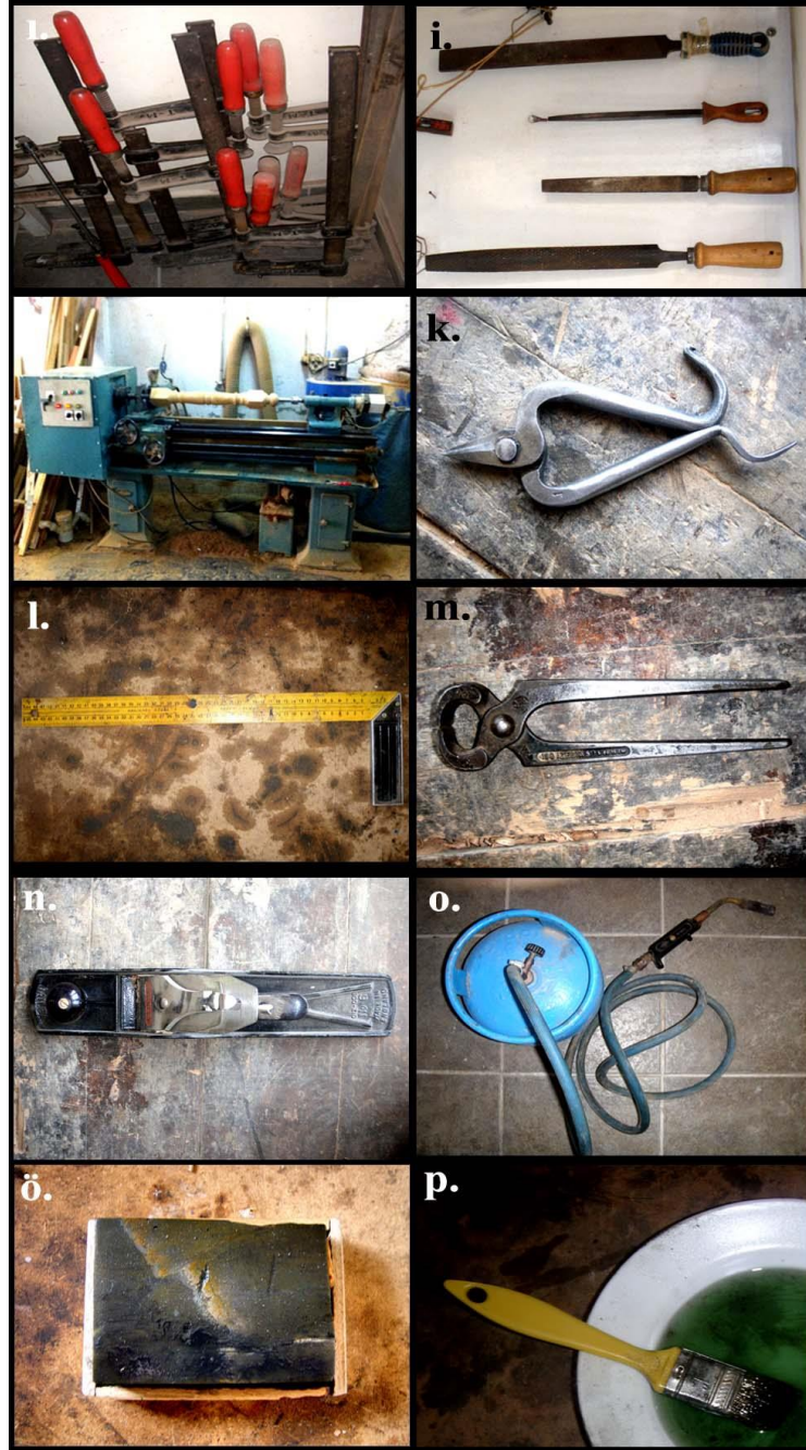
Şekil 56. Sedef Kakmacılıkta Kullanılan Araçlar; i. İşkenceler, i. Eğeler, j. Torna Makinesi, k. Çelik Makası, l. Gönye, m. Kerpeten, n. Rende, o. Pürmüz, ö. Bileği Taşı, p. Fırça (Aktürk 2012)
