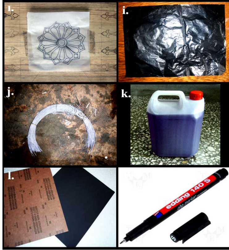
Şekil 58. Sedef Kakmacılıkta Kullanılan Gereçler; l. Aydınlar, i. Karbon Kâğıdı, j. Gümüş Tel, k. İspirto, l. Zımpara Kâğıdı, m. Asetat Kalem (Aktürk 2012)
