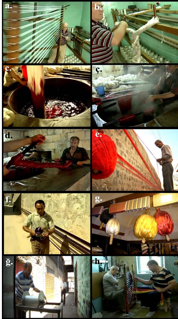
Şekil 49. Dokuma Öncesi İşlemler; a. Söküm İşlemi, b. Çözülen İpliklerin Şenk Haline Getirilmesi, c. Boyama İşlemi, ç. Boyama İşlemi, d. Boyanın Fazlalıklarının Alınması, e. Tertipleme, f. Kavuklama, g. Kavuklar, ğ. Makaralama, h. Taharlama (e.ğ Anonim 2011, diğerleri Ayşe Öksüz 2005)
