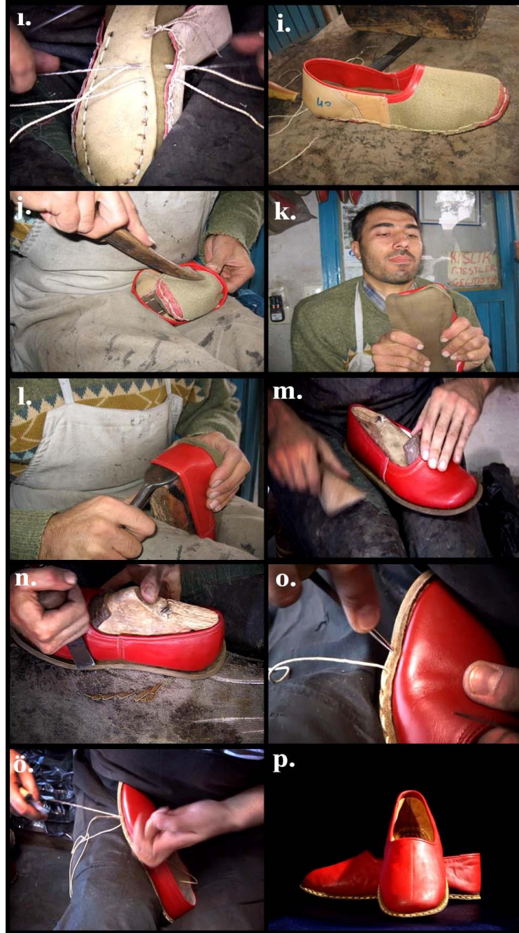
Şekil 84. Yemeni Yapım Aşamaları; l. Tersten Dikilmesi, i. Tersten Dikilmiş Hali, j. İhvan ile Çevrilmesi, k. Elle Düzeltilmesi, l. Peşkiç ile Kalıba Alınması, m. Kalıba Alınması, n. Kenar Fazlalıklarının Kesilmesi, o. Düz Tarafından Dikilmesi, ö. Düz Tarafından Dikilmesi, p. Ürünün Yapımının Tamamlanmış Hali (i,j,k,l Güler ve Özdemir 2006, diğerleri Anonim 2011)
