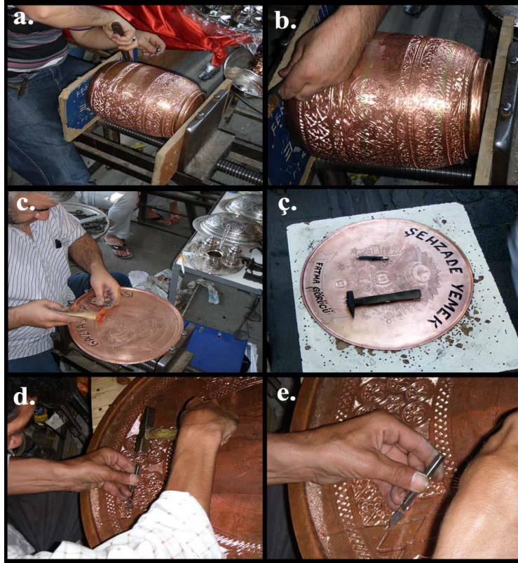
Şekil 29. Kazıma Tekniğinin Uygulanışı (Aktürk 2012)
