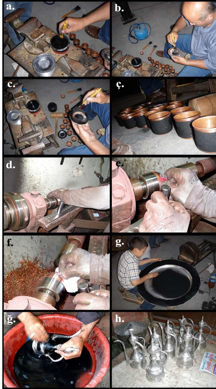
Şekil 30. Boyama Tekniğinin Uygulanışı; a. Boyanın Hazırlanması, b. Boyama İşlemi, c. Boyama İşlemi, ç. Boyanmış Ürün, d. Ürünün Tesviyesi, e. Ürünün Zımpara İle Tesviyesi, f. Ürünün Pamuk ile Tesviyesi, g. Ürünün Yıkanması, g. Ürünün Yıkanması, h. Boyama İşlemi Biten Ürün (Aktürk 2012)
