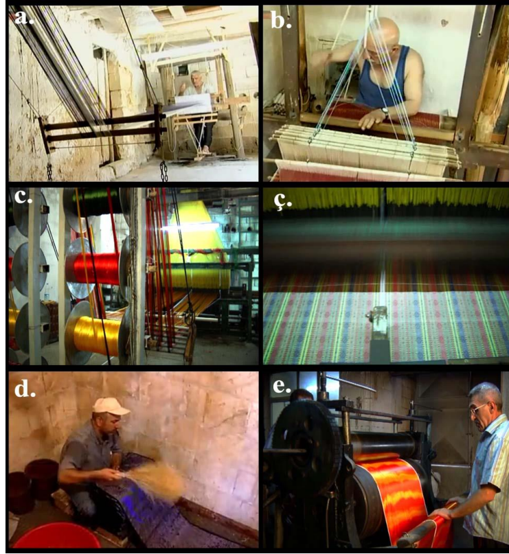
Şekil 50. Dokuma ve Dokuma Sonrası İşlemler; a. Kamçılı El Tezgâhında Dokuma, b. Kamçılı El Tezgâhında Dokuma, c. Motorlu Tezgâh ve Makaralar, ç. Motorlu Tezgâhta Dokuma İşlemi, d. Tavlama, e. Cendereleme (a,b,d Ayşe Öksüz 2005, diğerleri Anonim 2011)
