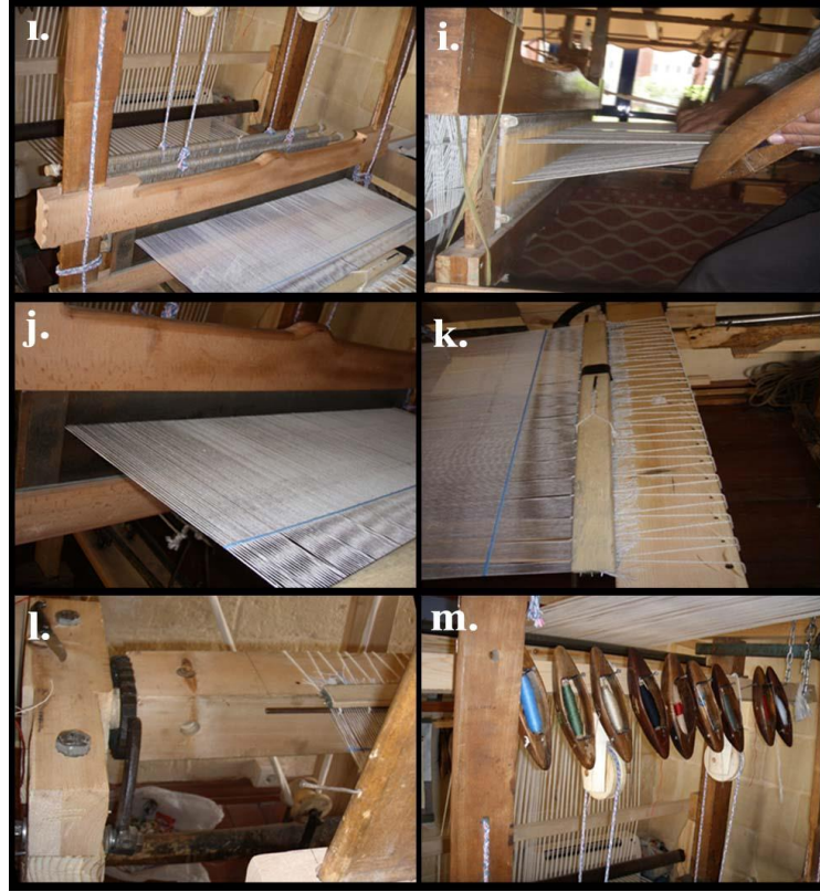
Şekil 41. Kilim Dokuma Tezgâhının Parçaları; ı. Tefe, i. Kamıştan Yapılmış Tefe Tarağı, j. Telden Yapılmış Tefe Tarağı, k. Mitit, l. Sermin ve Sermin Dışlisi, m. Düzen Ağacı (Aktürk 2012)
