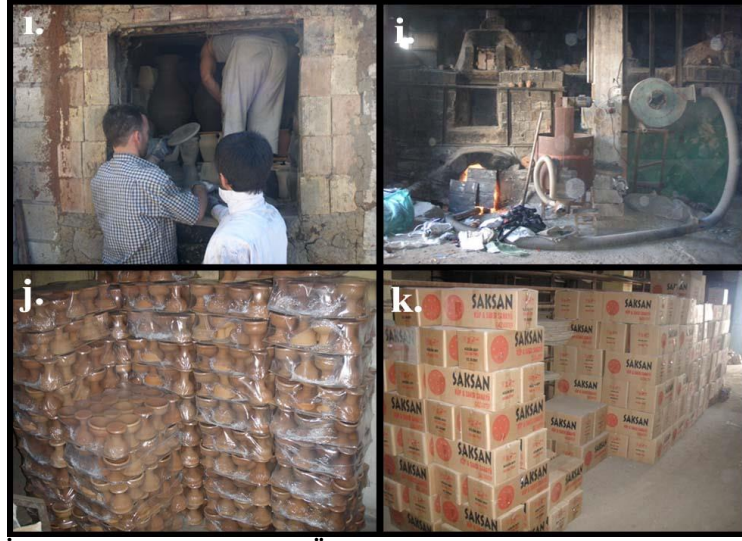
Şekil 74. Toprak İşleri Yapım Aşamaları; ı. Ürünlerin Fırına Yerleştirilmesi, i. Fırınlama, j. Paketlenmiş Ürünler, k. Kutulanmış Ürünler (Aktürk 2012)
