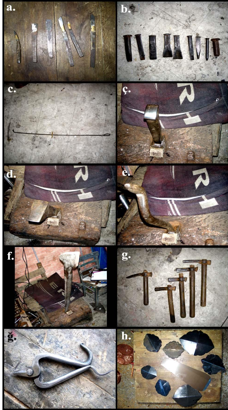
Şekil 21. Bakır İşlemeciliğinde Kullanılan Araçlar; a. Kalemler, b. Keskiler, c. Çızağı, ç. Topak Örs, d. Halep Örsü, e. Deve Boynu Örs, f. Milimgi, g. Çekiçler; Soldan Sağa: Karga burun Nari, Topak Miyene, Miyene, Nari, ğ. Demir Makası, h. Desen Kalıpları (Aktürk 2012)
