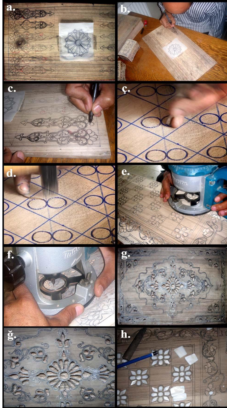
Şekil 60. Sedef Kakmacılığının Yapım Aşamaları; a. Aydınır Kâğıdı İle Desenin Aktarılması, b. Desenin Çizilmesi, c. Desenin Asetat Kalem İle Belirginleştirilmesi, ç. Motiflerin Etrafına Yuvaların Açılması, d. Açılan Yuvalara Telin Yerleştirilmesi, e. Sedeflerin Yuvalarının Oyulması, f. Sedeflerin Yuvalarının Oyulması, g. Sedef Yuvaları Oyulmuş Ahşap, ğ. Ayrıntı, h. Sedeflerin Yuvalarına Uygun Biçimde Kesilmesi (ç,d Anonim 2011, diğerleri Aktürk 2012)
