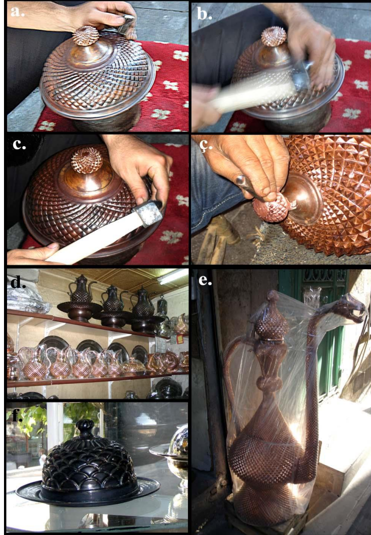
Şekil 31. Kabartma Tekniğinin Uygulanışı; a , b , c , ç , Farklı Uçlardaki Keski İle Kabartma İşlemi, d. Kabartma Tekniği Uygulanmış Ürün, e. Kabartma Tekniği Uygulanmış Ürün, f. Kabartma Tekniği Uygulanmış Ürün (Aktürk 2012)
