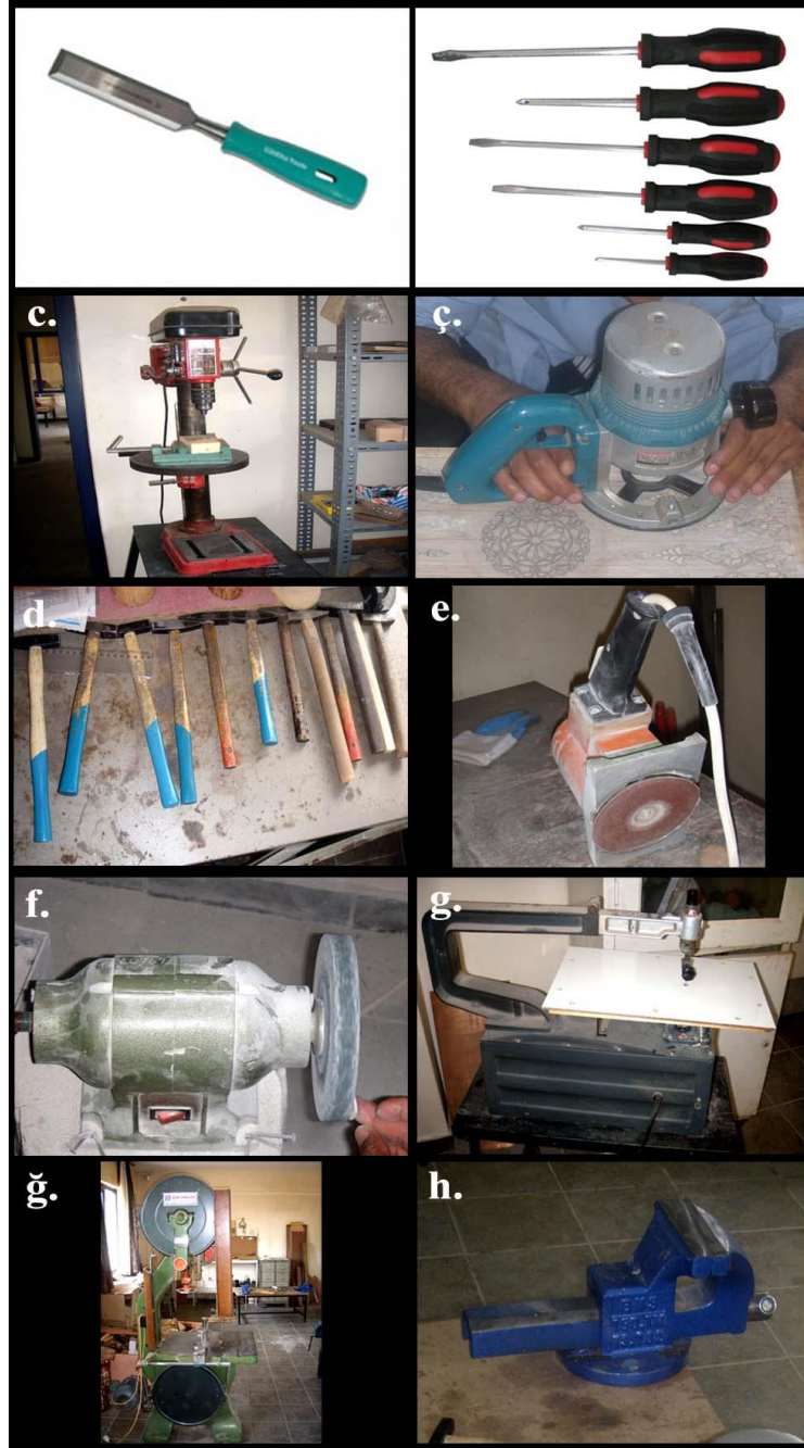
Şekil 55. Sedef Kakmacılıkta Kullanılan Araçlar; a. İskarpile, b. Tornavidalar, c. Matkap, ç. Freze Makinesi, d. Çekiçler, e. Zımpara Makinesi, f. Taş Motoru, g. Kıl Testere, ğ. Hızır, h. Mengene (Aktürk 2012)
