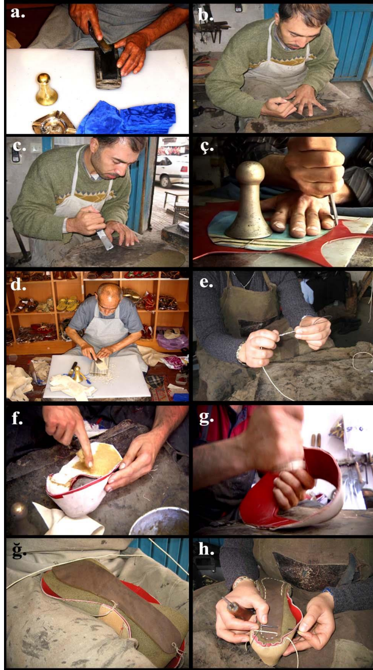
Şekil 83. Yemeni Yapım Aşamaları; a. Keskinin Bilenmesi, b. Tabanın Kesilmesi, c. İç Astarın Kesilmesi, ç. Sahtiyanın Endazeye Uygun Olarak Kesilmesi, d. İç Astarın Düzgünleştirilmesi, e. İpliğin Bükülmesi, f. Çiriş ile İç Astarın Yapıştırılması, g. Muşta ile Sahtiyanın Dövülmesi, ę. Çatma İşlemi, h. Ürünün Tersten Dikilmesi (a,d Aktürk 2012, ç,f,g, Anonim 2011, diğerleri Güler ve Özdemir 2006)
