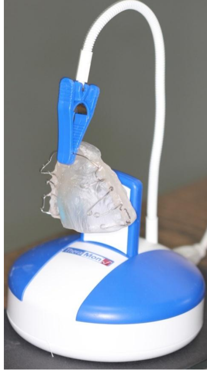
Resim 5. RFID okuma cihazı ve aktivatörün konumlandırılması
