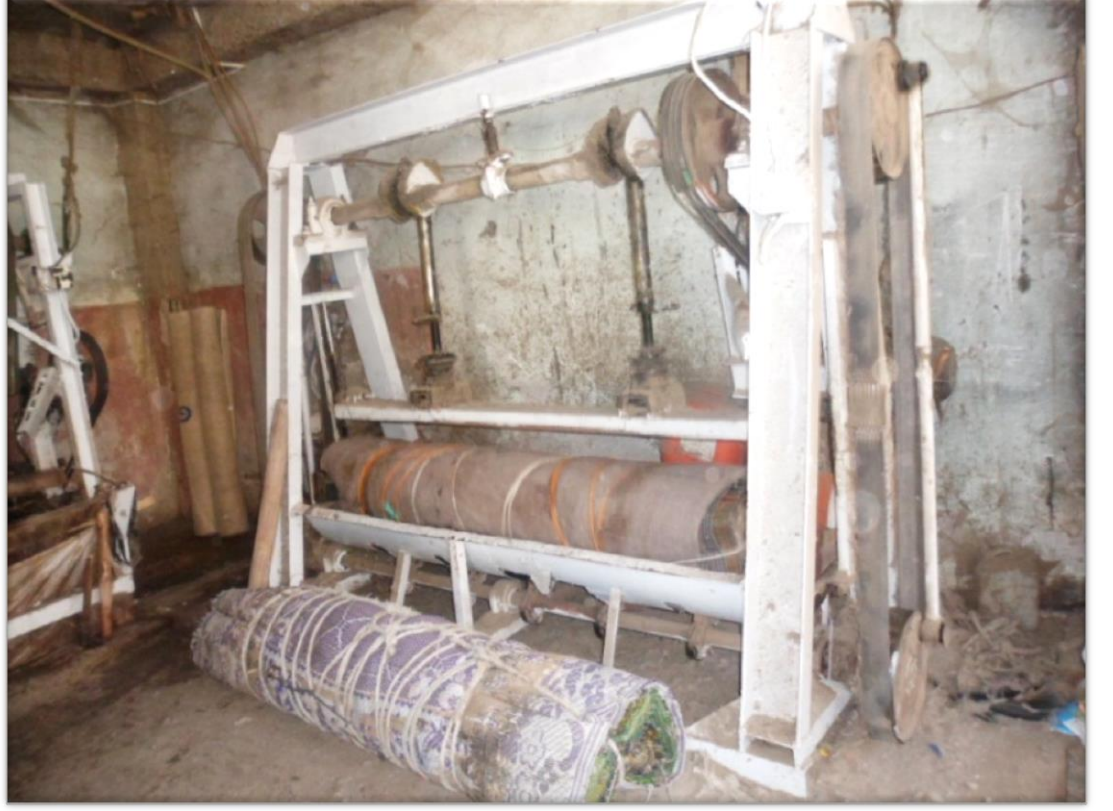
Şekil 4. 79.Tepme ve pişirme işlemlerini yapacak olan tepme makinesi(Önder,2011)
