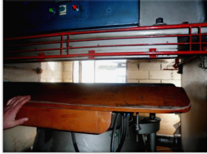
Şekil 4. 101.Deriyi düzeltecek, ütüleyecek olan pres ütü makinesi(Önder,2011)
