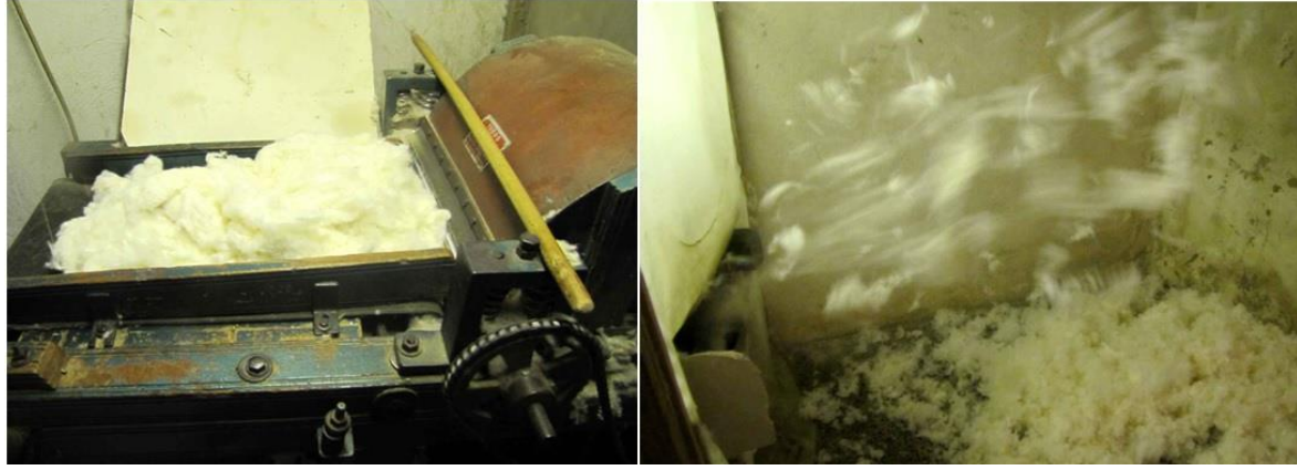
Şekil 4. 28.Çırpı makinesi ve çırpılan pamuklar(Çeliker,2012:18)
