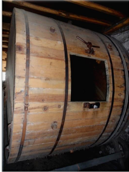
Şekil 4. 97.Mil ile dönen ahşap yıkama dolabı(Önder,2011)
