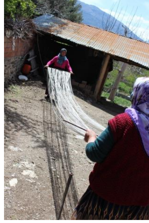
Şekil 41. Çözügünün Gerginleştirilmesi (Solmaz Sarıgöl-Yukarıtırtar Köyü, 2014) (Kılıçarslan 2014)
