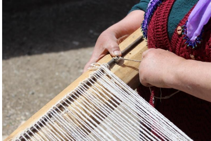
Şekil 42. Çözügünün Üst Leventteki Yerde Demir Yatağına Geçirilmesi (Solmaz Sarıgöl-Yukarıtırtar Köyü, 2014) (Kılıçarslan 2014)
