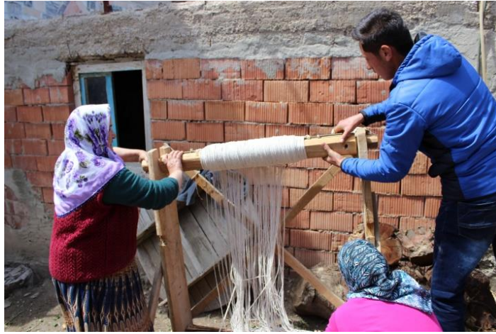
Şekil 44. Çözgünün Tezgaha Aktarılması (Solmaz Sarıgül-Yukarıtirtar Köyü, 2014) (Kılıçarslan 2014)
