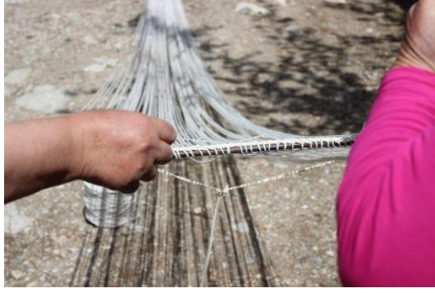
Şekil 40. Çözügünün Demir Çubuklara Geçirilmesi (Solmaz Sarıgöl-Yukarıtırtar Köyü, 2014) (Kılıçarslan 2014)
