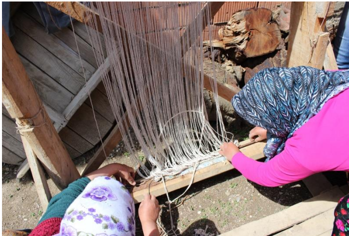
Şekil 45. Çözgünün Alt Leventteki Yerde Demir Yatağına Geçirilmesi (Solmaz Sarıgül-Yukarıtirtar Köyü, 2014) (Kılıçarslan 2014)
