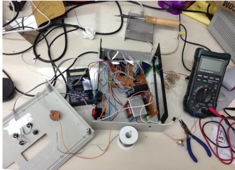
Resim 20. Prototip elektroliz cihazının üretim aşaması.
