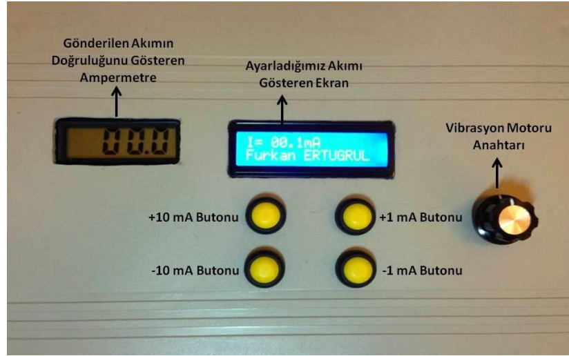
Resim 21. Prototip cihazın ön yüzündeki dijital ekranlar ve butonları.
