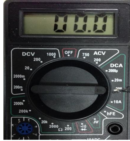
Resim 23. Prototip cihazın içerisinde yer alan ampermetre. (Enjektörün içerisindeki NaOCl'den geçen akımın doğruluğunu kontrol etmek için)
