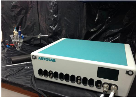
Resim 7. NaOCl solüsyonundan elektrik akımını geçmesini sağlayan elektroliz cihazı.
