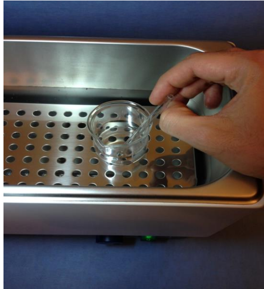
Resim 16. NaOCl solüsyonunun sıcaklık banyosunda iken cam pipet ile aktive edildiği an.
