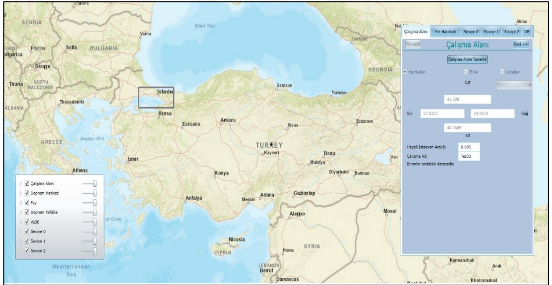
Şekil 4.1: İnternet tabanlı deprem hasar tahmin algoritması arayüzü.
