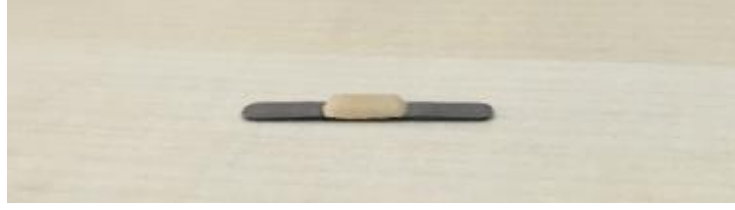
Resim 17. Tesviyesi tamamlanmış metal-seramik örnek.
