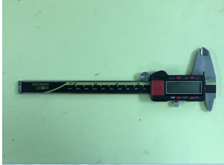
Resim 19. Ölçümlerde kullanılan kumpas.
