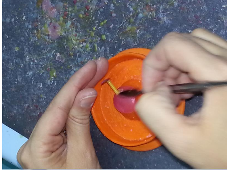
Resim 2. Mum 6rneklere d6k6m kanallarının baęlanması ve manşete alma.
