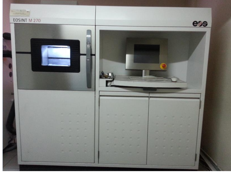
Resim 15. Üretimin gerçekleştirildiği lazer sinterizasyon cihazı.
