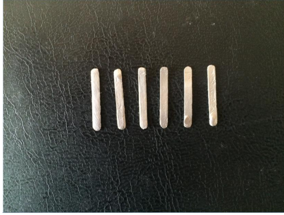
Resim 9. Seramik pişimi için hazırlığı tamamlanmış döküm metal örnekler.
