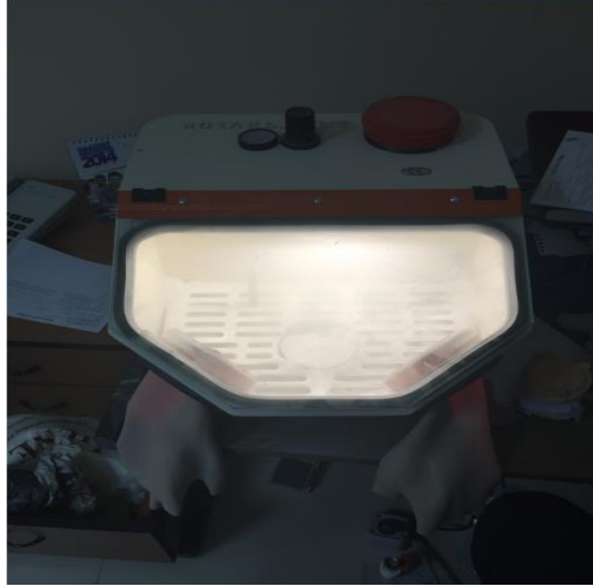
Resim 7. Rotaks kumlama cihazı.
