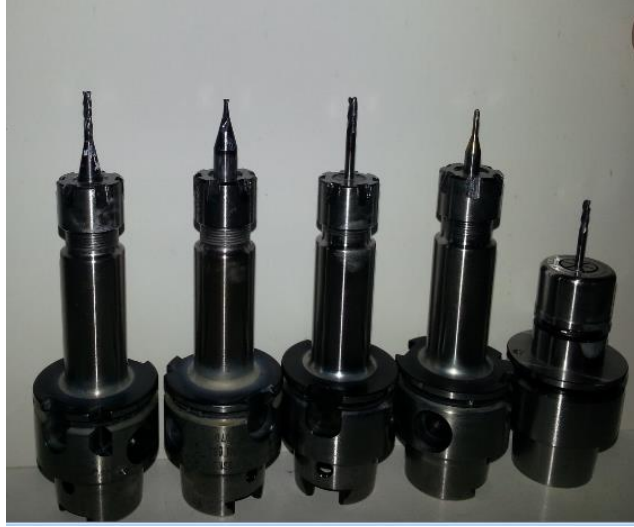
Resim 11. Milleme esnasında kullanılan uçlar.
