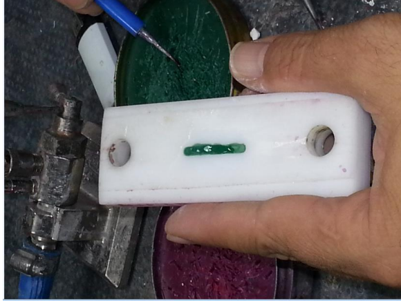
Resim 1. Hazırlanan şablonlara mum eritilmesi ve mum örneklerin hazırlanması.
