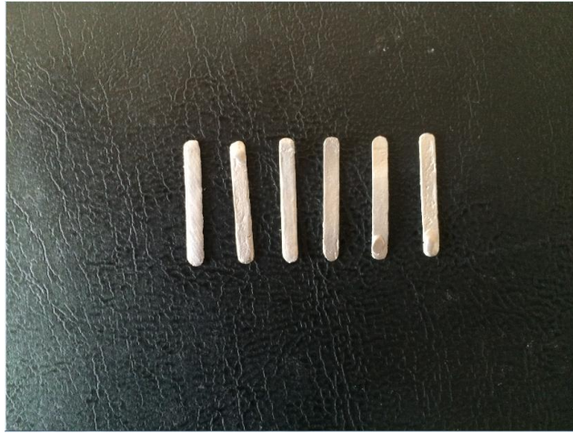
Resim 14. Seramik pişimi için hazır olan metal örnekler.
