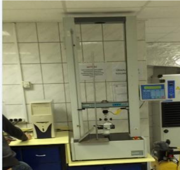
Resim 18. Testin yapıldığı Universal Test Cihazı.
