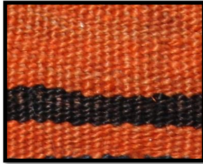
Şekil 7. Düz Atkı Yüzlü Dokuma (Acar, 1982, S:44).
