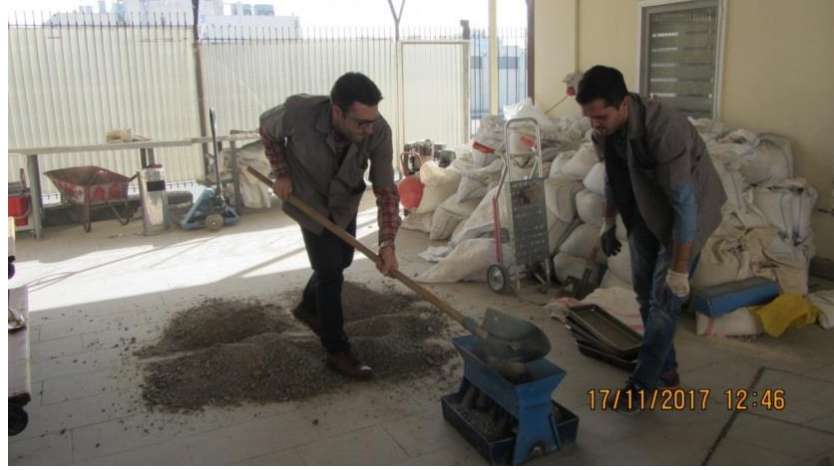
Şekil 3.10. Elek analizi için çeyrekleme (dörtleme) yöntemi ve bölgeçe numune alınması
