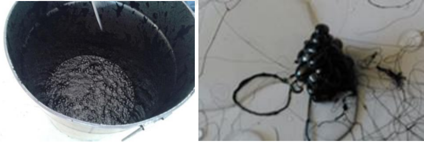
Şekil 3.45. Köpürmüş bitümün söndükten sonraki hali ve kova dışına sıçramış köpürmüş haldeki bitüm
