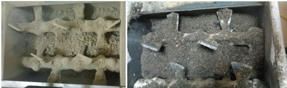
Şekil 3.48. Malzemelerin kuru karışım ve su-bitüm ilavesi sonrası karışmış halleri
