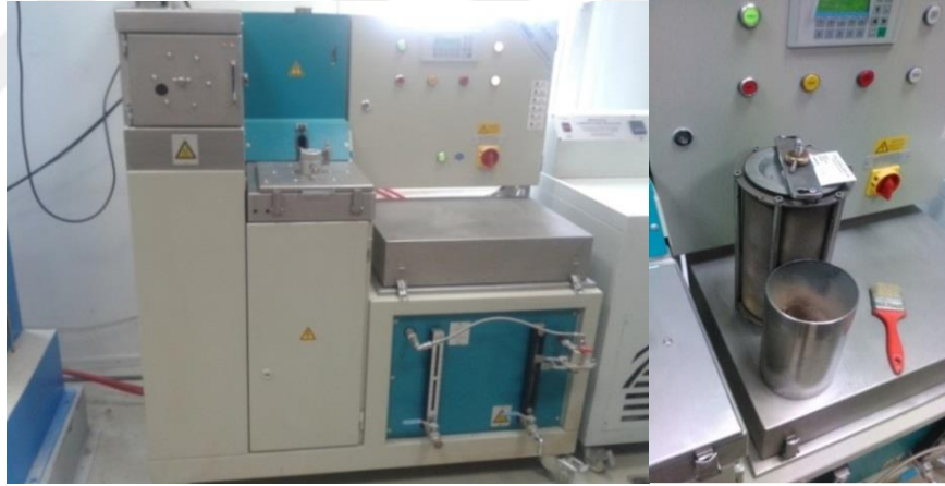
Şekil 3.4. Asfalt analizatörü ve analizatörden çıkan ayrışmış agrega ve filler
