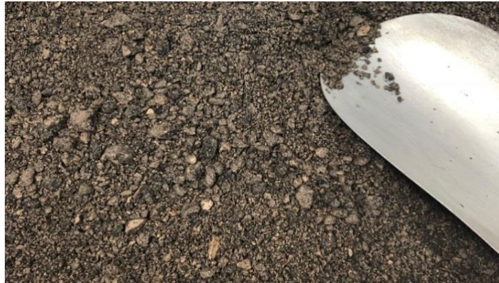
Şekil 5.1. Köpük bitümle stabilize malzeme
