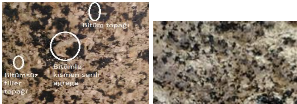
Şekil 4.8. Solda Şekil a'da görülen %3,1 bitümle üretilmiş KBSM ve sağda Şekil b'de %2,2 bitümle üretilmiş KBSM
