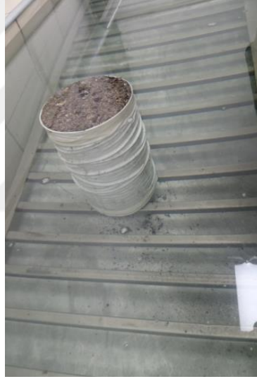
Şekil 3.57. Islak numunelerin etüv sonrası su içerisinde şartlandırılması
