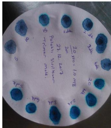
Şekil 3.20. Metilen mavisi deney sonu
