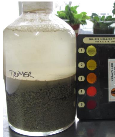
Şekil 3.17. Sodyum Hidroksit çözeltisinde bekletilmiş RAP numunesi
