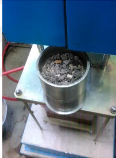
Şekil 3.29. RAP içerisindeki bitümün aktifliğinin kontrolü için briket hazırlanması
