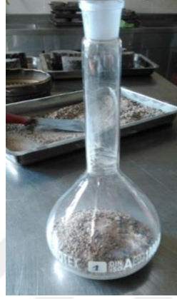
Şekil 3.22. Piknometre içerisinde kuru numune
