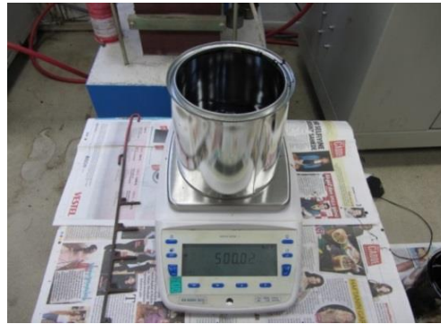
Şekil 3.41. Yükseklik ölçümü için 500 g bitüm tartılması
