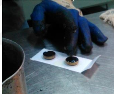
Şekil 3.33. Bitümün yüzüklere yerleştirilmesi
