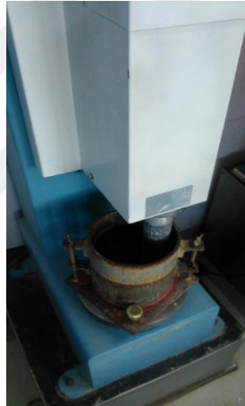
Şekil 3.25. Numunenin modifiye proktor ile sıkıştırılması
