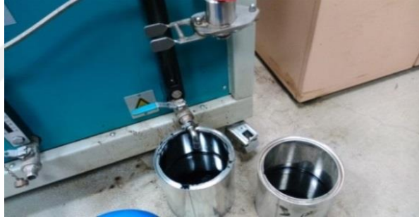
Şekil 3.6. Asfalt analizatörü ile ayrıştırılmış eski bitüm
