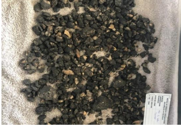
Şekil 3.21. Kuru yüzey suya doymun hale getirilen agregalar
