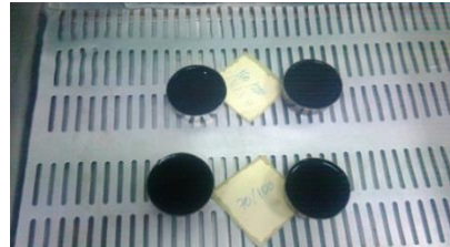
Şekil 3.31. Su banyosunda bekleyen penetrasyon deney numuneleri
