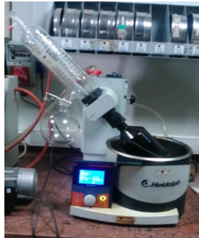
Şekil 3.7. Destilasyon cihazı ve RAP'den elde edilen bitüm
