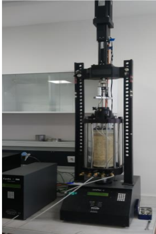
Şekil 3.58. KBSM numunesine Esneklik Modülü deneyi yapılması
