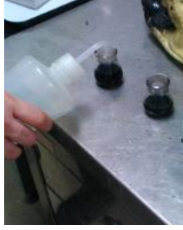
Şekil 3.38. Soğuyan bitümün üzerine saf su koyulması
