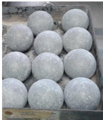
Şekil 3.13. Deneyde kullanılan 45-49 mm çapında ve toplam 4690-4890 g ağırlığındaki bilyeler
