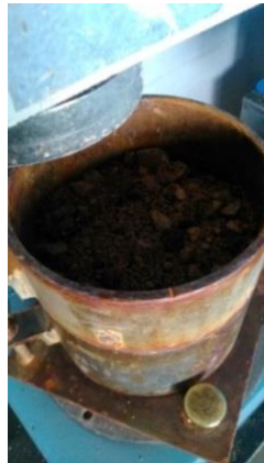
Şekil 3.26. Sıkışmış tabaka üzerine malzeme eklenerek yeni tabakanın sıkıştırılması için kalıbın cihaza yerleştirilmesi
