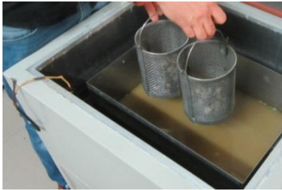
Şekil 3.16. Tel sepetteki agregaların magnezyum sülfat çözeltisine koyulması
