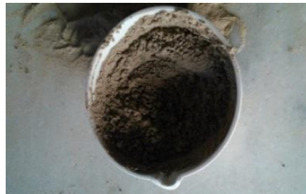
Şekil 3.24. Plastik limit deneyi için hazırlanan numune
