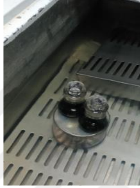
Şekil 3.39. Deney numunelerinin su banyosunda bekletilmesi
