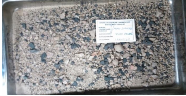
Şekil 3.5. Bitümden ayrıştırılmış kazınmış BSK
