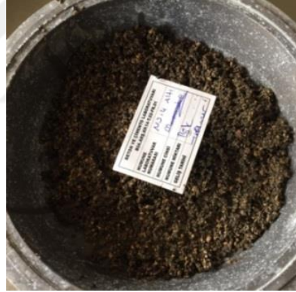
Şekil 3.23. No.4 elek altı santrifüjden çıkmış malzeme
