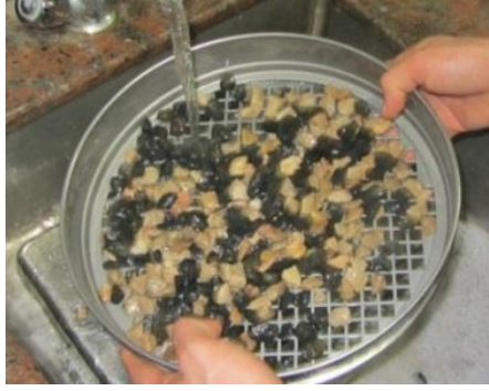
Şekil 3.15. Bitümden ayrıştırılmış agregaların hava tesirlerine dayanıklılık testi için yıkanması
