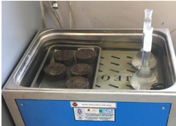
Şekil 3.52. Numunelerin 25°C suda şartlandırılması
