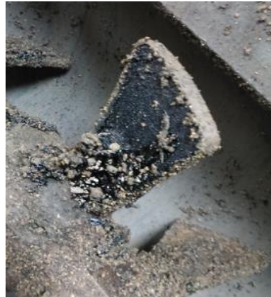
Şekil 3.46. Karıştırma haznesi bıçaklarına yapışan ve karışıma katılamamış olan bitüm
