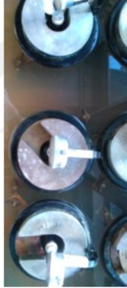
Şekil 3.27. Suda bekletilen CBR numuneleri
