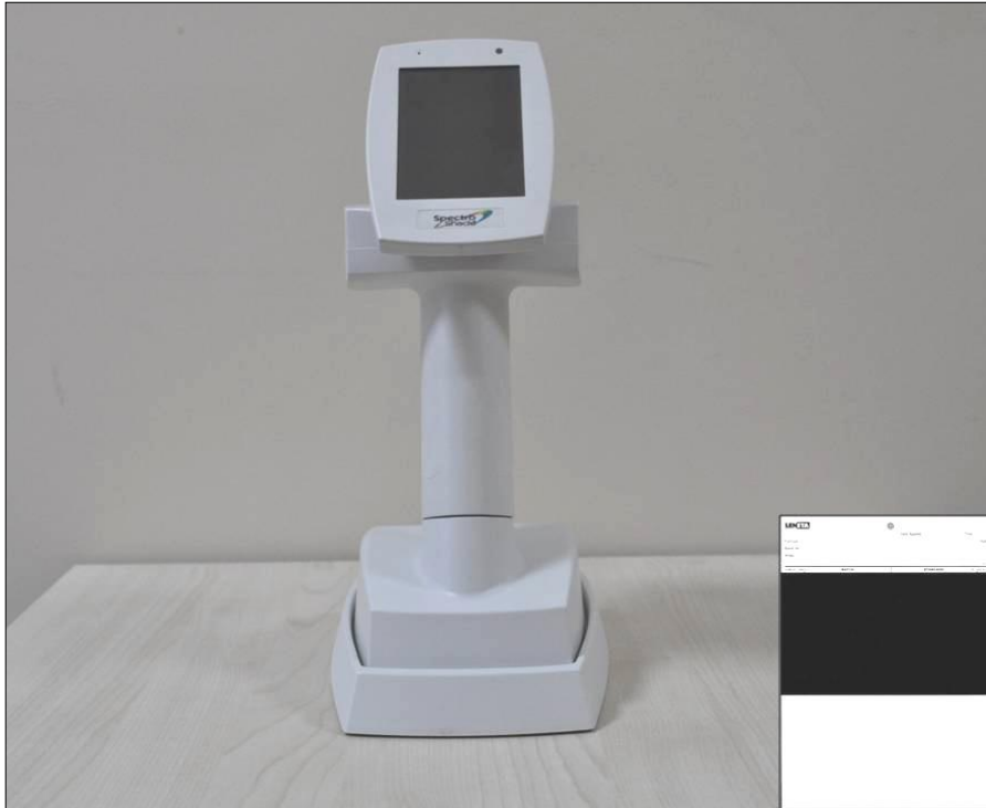
Resim 15. Dental spektrofotometre cihazı (Spectroshade Micro, MHT, İtalya) ve standart siyah zemin (Leneta, Mahwah, ABD).
