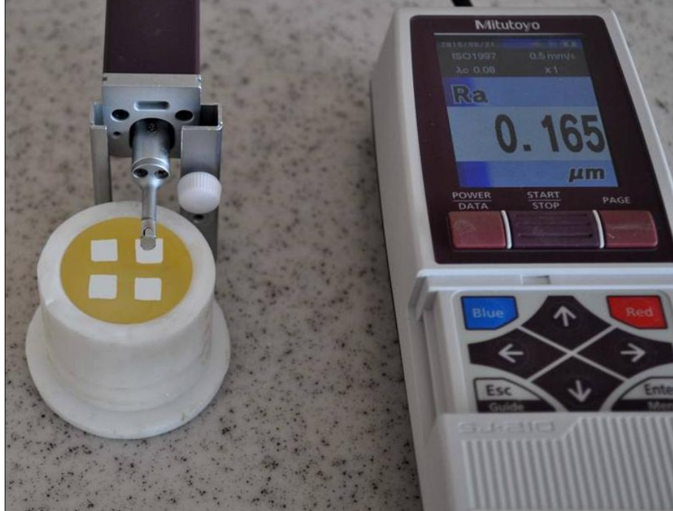
Resim 12. Profilometre cihazı ve 5 µm çapındaki ölçüm ucu ile yüzey pürüzlülüğü ölçümünün gerçekleştirilmesi.
