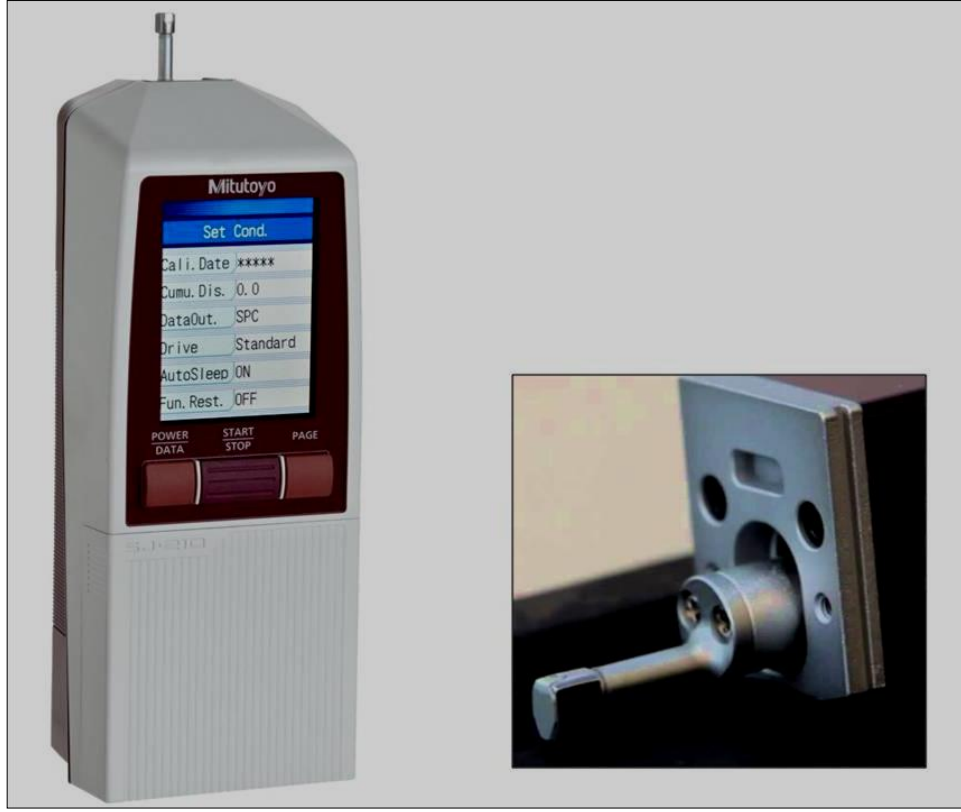
Resim 11. Profilometre cihazı (SurfTest SJ-210 Mitutoyo, Tokyo) ve ölçüm ucu.
