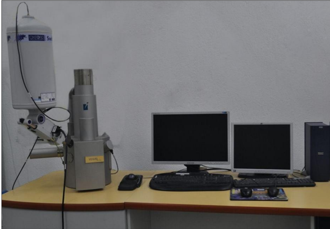
Resim 13. Taramalı elektron mikroskobu (Vega II, Tescan, İngiltere).
