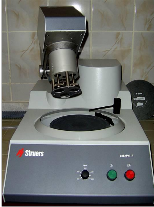
Resim 2. Otomatik polisaj cihazı (Labopol 5, Struers, Danimarka).
