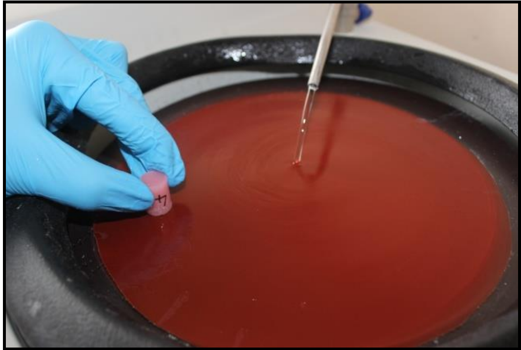
Resim 7. Örneklerin zımpara işlemi
