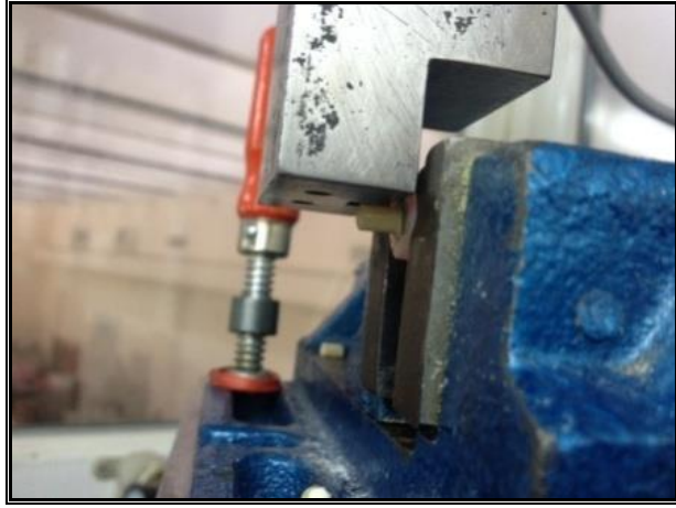
Resim 20. Kuvvet kolu bağlantı noktasına dik açıyla gelecek şekilde ayarlandı
