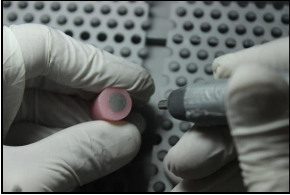
Resim 8. Örneklerin kumlama işlemi
