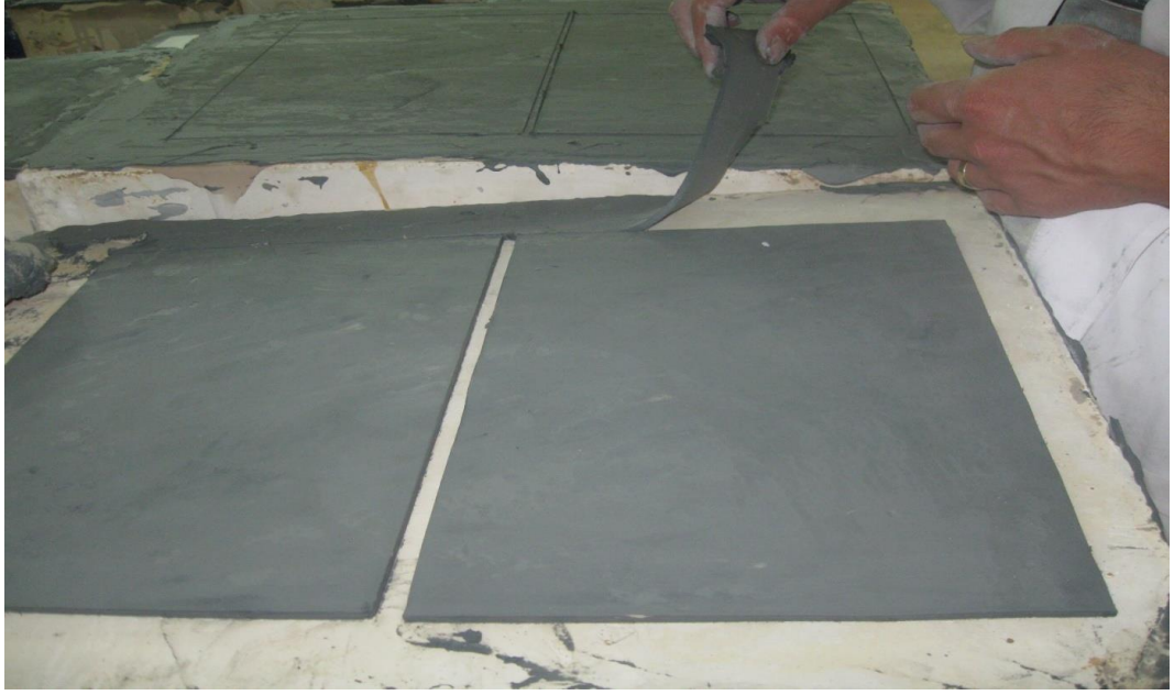
Resim 121. Alçı kalıplar üzerinde düz plakaların yapımı
