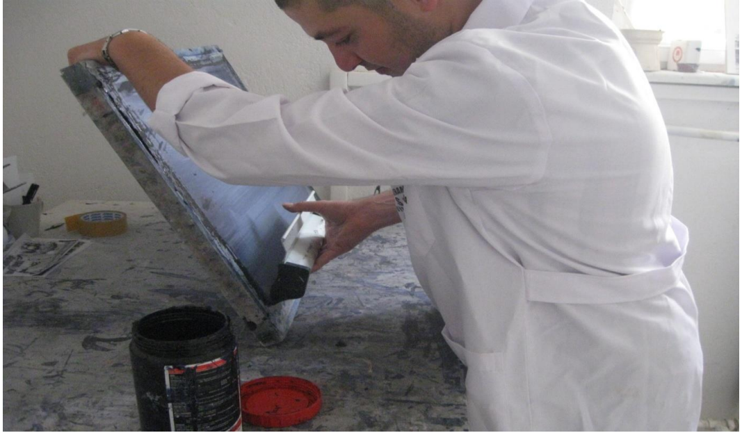
Resim 125. Pozlama yapılabilmesi için eleğe emülsiyon çekilmesi
