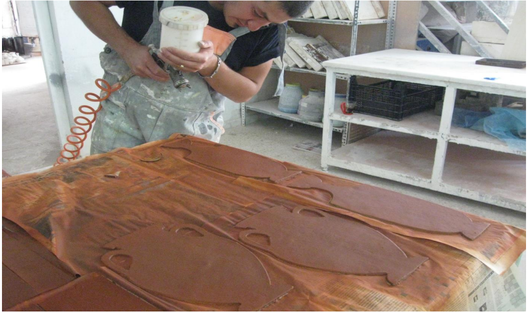
Resim 123. Deri sertliğine gelen ürünlerin üzerine astar atımının yapılması
