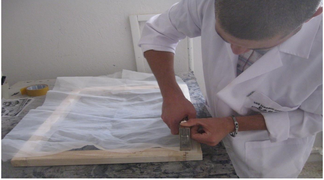
Resim 124. Serigrafi baskı yapımı için eleğin çerçeveye gerilmesi
