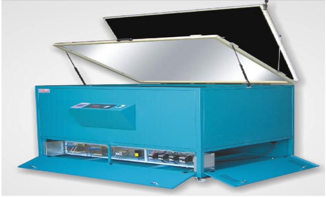
Resim 109. Serigrafide kullanılan pozlama makinesi
