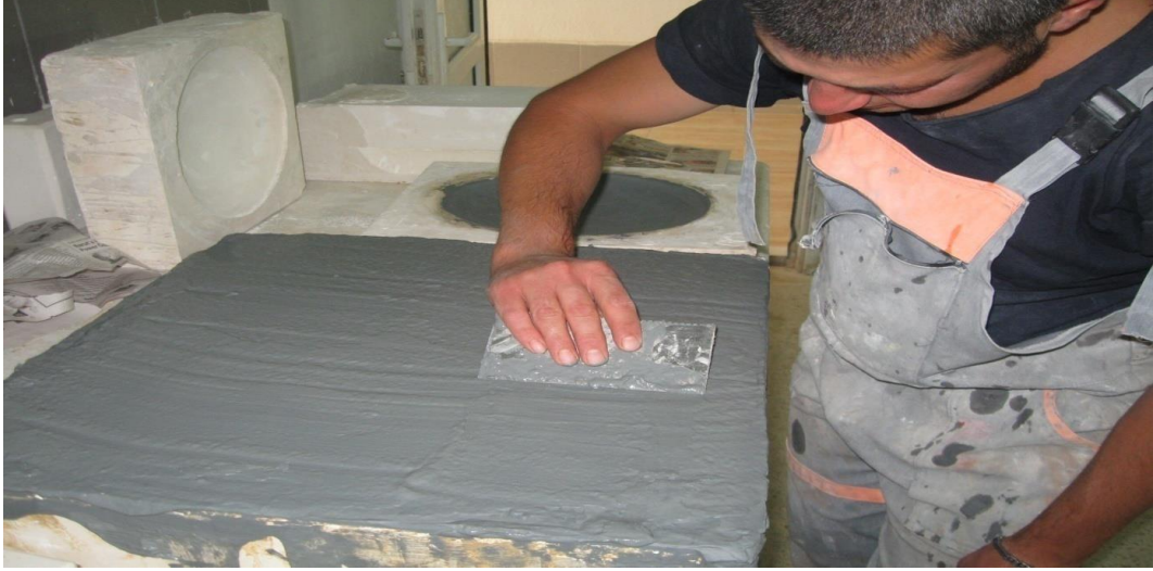
Resim 114. Hazır haldeki çamurun plastik kıvama gelmesi için alçı plakalar üzerine serilmesi
