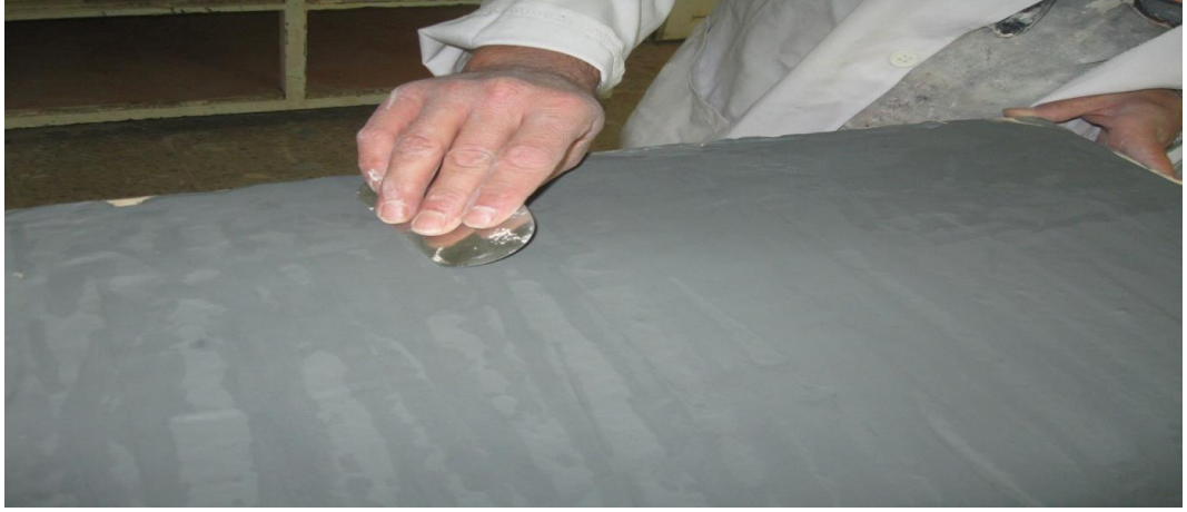
Resim 116. Plastik hale gelen çamurun şekillendirilmeden önce rötuşunun yapılması
