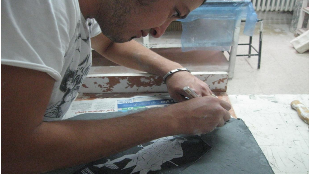
Resim 117. Plastik çamur üzerine şablonun koyularak kesilmesi
