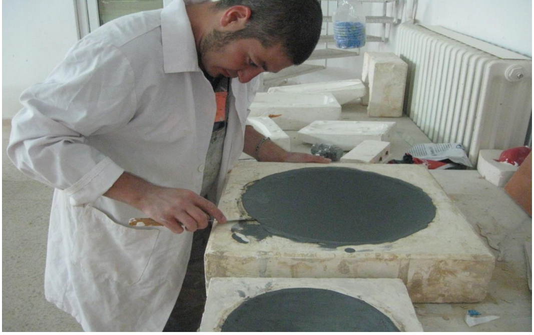
Resim 122. Plakaların alçı kalıplar içerisinde basılarak, şekillendirmelerinin yapılması
