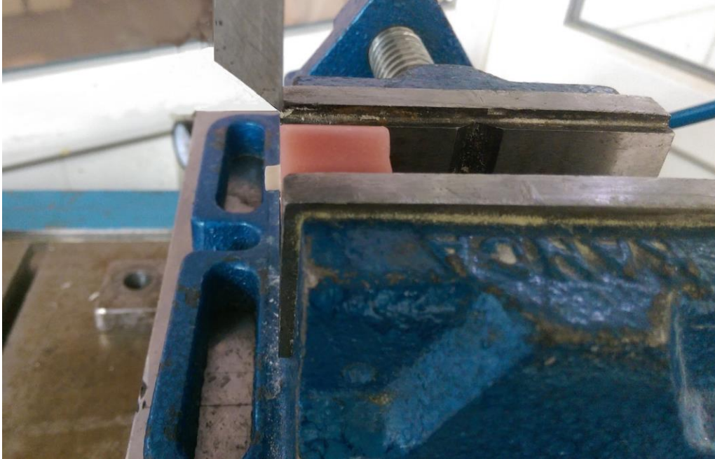
Resim 15. Test cihazı içine yerleştirilmiş deney örnekleri
