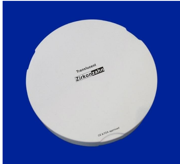
Resim 1. Deney örneklerinin hazırlandığı zirkonyum dioksit blok
