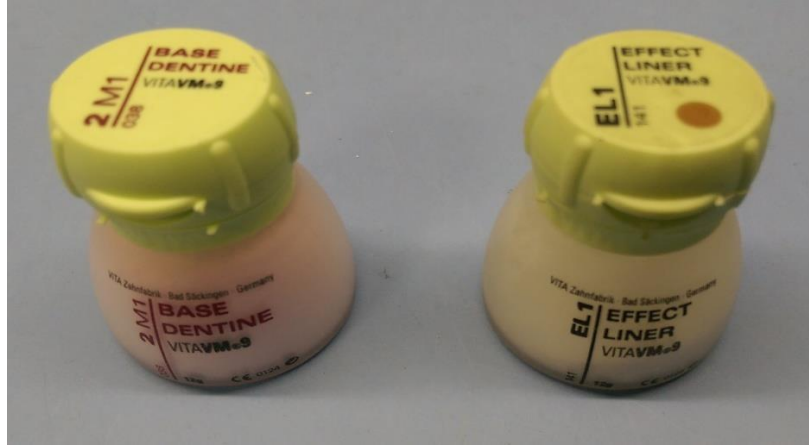
Resim 11. Örneklerin hazırlanmasında kullanılan Vita VM9 porselen tozları
