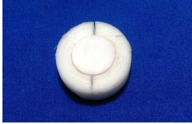
Resim 8. Zirkonyum dioksit disklerin teflon kalıplara yerleştirilmesi
