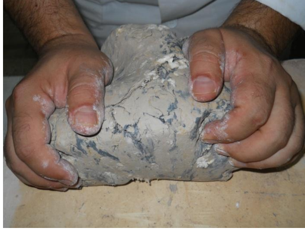
Resim13. Kağıt katkılı seramik çamurunun alçı plaka üzerinde yoğrulması
