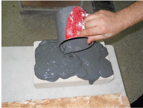
Resim 11. Kağıt ve döküm çamuru karıştırıldıktan sonra alçı plaka üzerine yayılması
