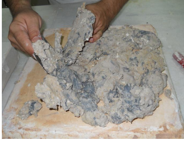
Resim 12. Kağıt ve döküm çamurunun alçı plaka yüzeyinden toplanması.
