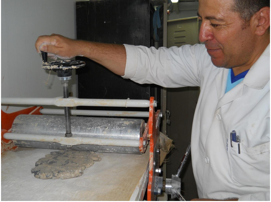
Resim 22. Çamur açma makinası kullanarak plaka açma
