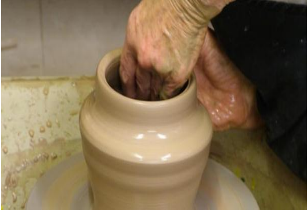
Resim 23. Torna yöntemi ile şekillendirme
