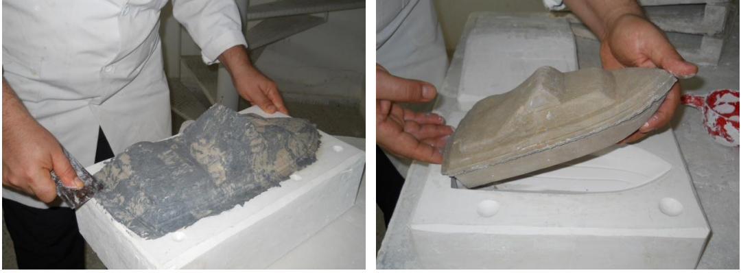
Resim 63. Kalıp yöntemi ile şekillendirme
