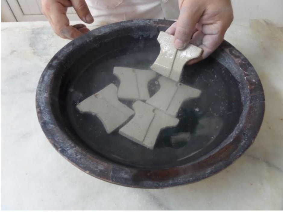
Resim 18. Su emme deneyi
