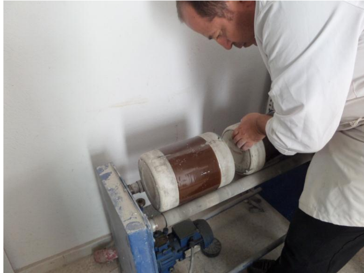
Resim 30. Bilyalı değirmende astar hazırlanması
