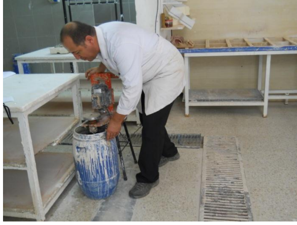
Resim 8. Parçalanmış tuvalet kağıtlarının su ile ıslatılıp pervaneli açıcıda karıştırılması
