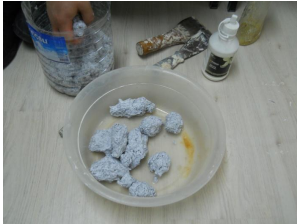
Resim 10. Kağıt hamurunun fazla suyunun sıkılarak uzaklaştırılması
