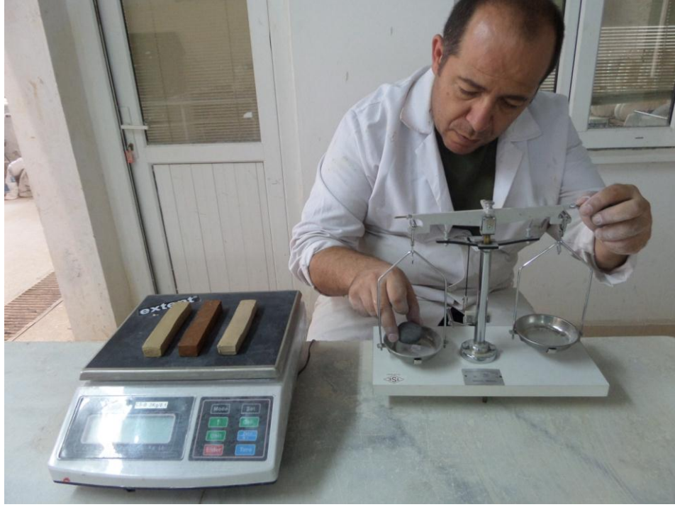
Resim 14. Kağıt katkılı bünyede yoğrulma suyu deneyi
