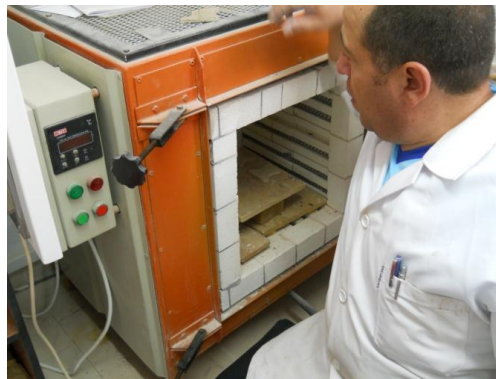
Resim 16-17. Etüv’de kurutma –Deney Fırınında, deney plakası pişirimi
