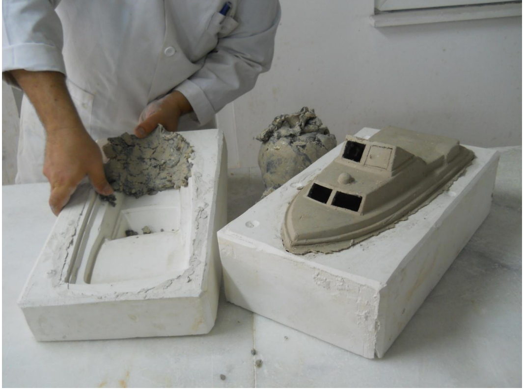
Resim 25. Baskı yöntemi ile şekillendirme
