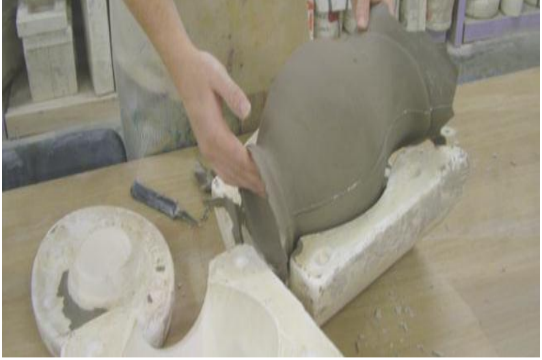
Resim 24. Döküm yöntemi ile şekillendirme
