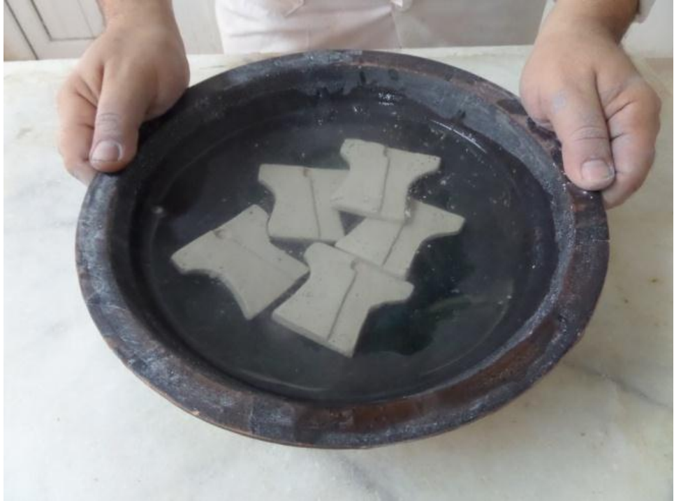
Resim 19. Su emme deneyi
