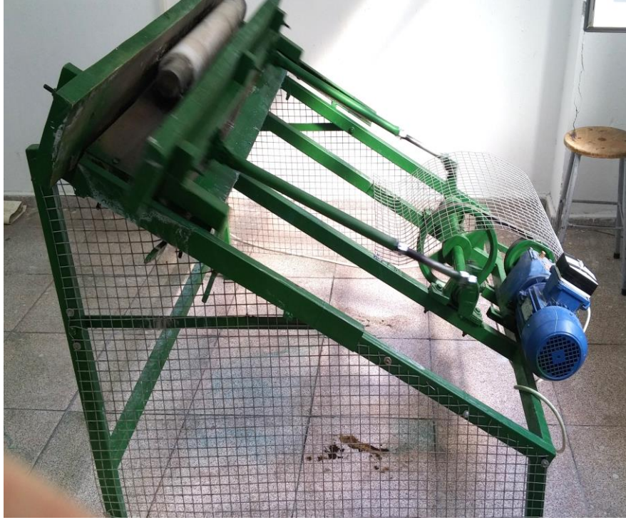
Şekil 64: Keçe Tepme Makinasında Dövülme İşlemi (Sevinç, 2015).
